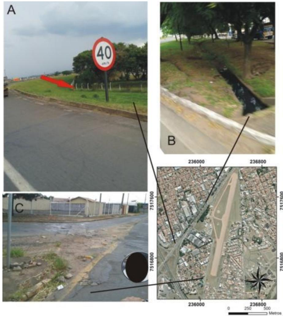
Figura 67 – Caimento antrópico (seta vermelha) contrário ao caimento topográfico natural (A); Canal artificial (B); Asfalto deteriorado em função da ação das águas correntes (C). Acervo pessoal: Fotos de março/2015.
