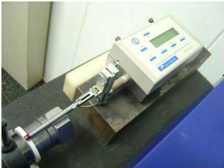
Figura 48 - Exemplo de operação de medição de rugosidade.
