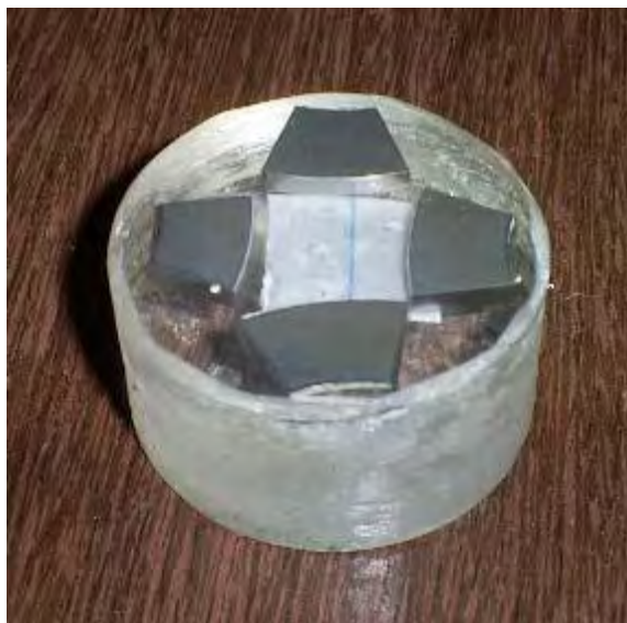
Figura 50 - Amostra preparada para a análise de microdureza e microscopia.
