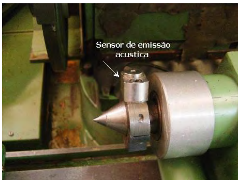
Figura 45 - Sensor fixo posicionado no cabeçote móvel.
