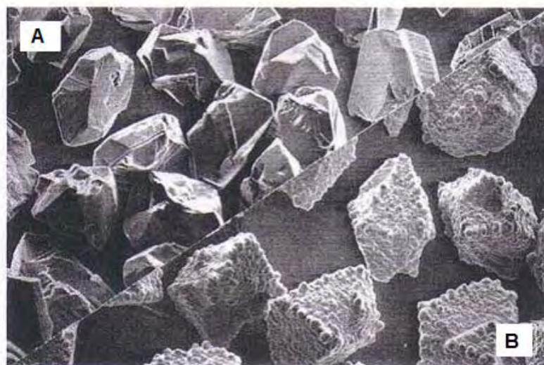
Figura 4 - CBN: a – Tipo I; b- Tipo II – GE Superabrasives (KRAR & RATTERMAN, 1990).
