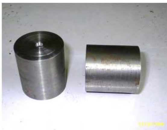
Figura 24- Geometria do corpo de prova usado para a marcação do desgaste do rebolo.
