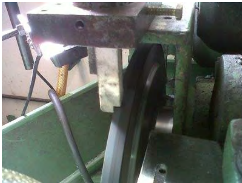
Figura 41 - Posição do bastão em relação ao reboło.
