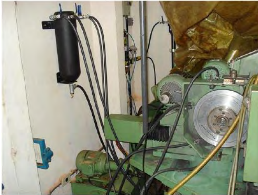
Figura 34 - Fixação dos bocais de limpeza na retificadora. (Oliveira et al. 2012)
