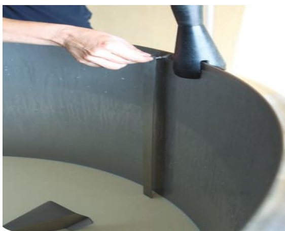
Figura 3. Colocação da régua no tanque de expansão. Fonte: Senar (2016).
