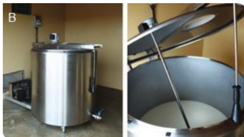
Figuras 1 e 2. Tanque de resfriamento (expansão) para armazenamento de leite de vaca pós-ordenha. Fonte: A= Dias et al. (2015); B= Senar (2016).
