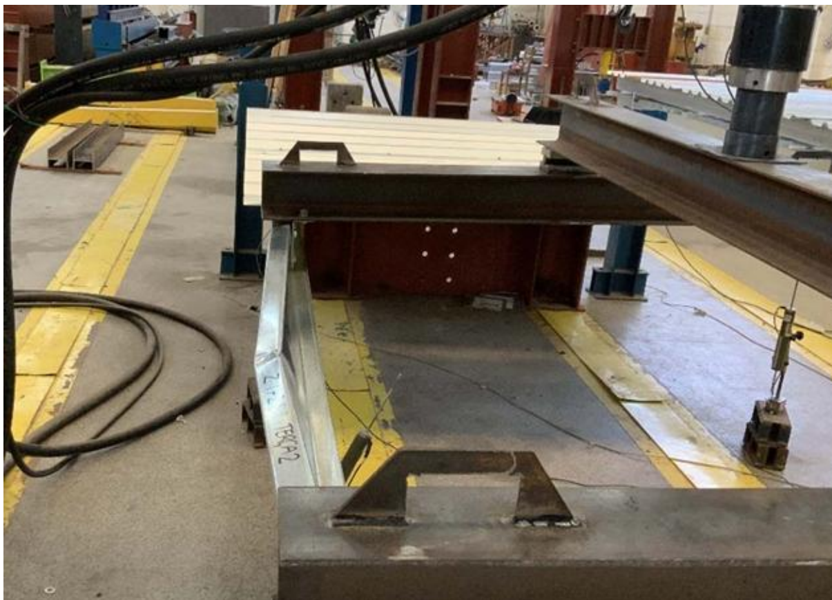
Figura 6 – Configuração deformada de falha do protótipo Z 172-ST
