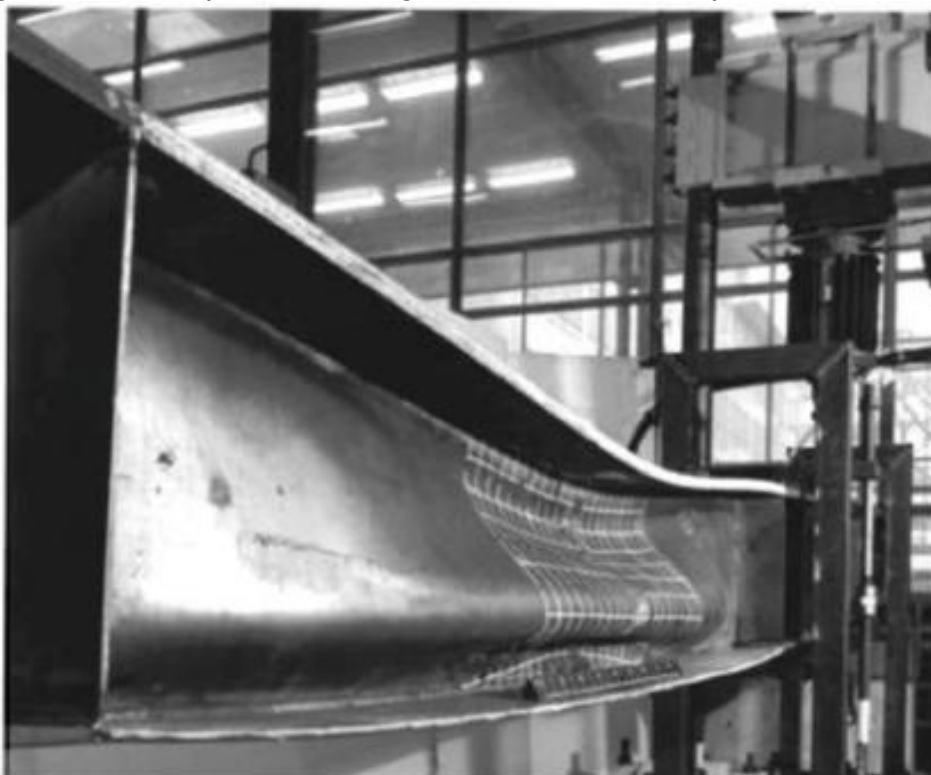
Figura 3 – Exemplo de flambagem local da alma de perfil formado a frio
