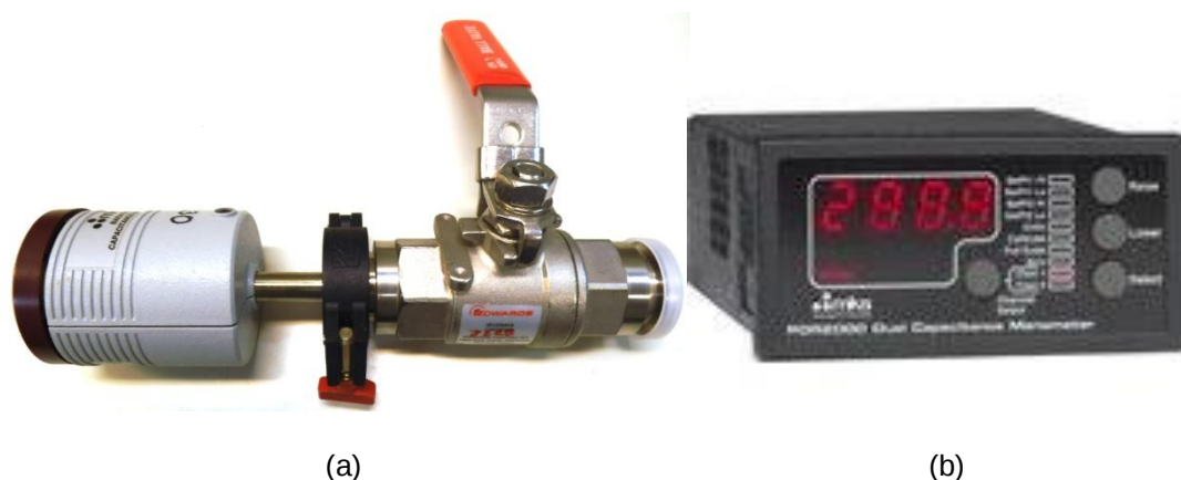
Figura 3.5 – (a) Sensor de pressão, MKS, de membrana capacitiva acoplado a válvula esférica, Edwards. (b) Controlador de pressão, MKS, interpreta os sinais elétricos enviados pelo sensor de pressão e os apresenta em um display digital.
