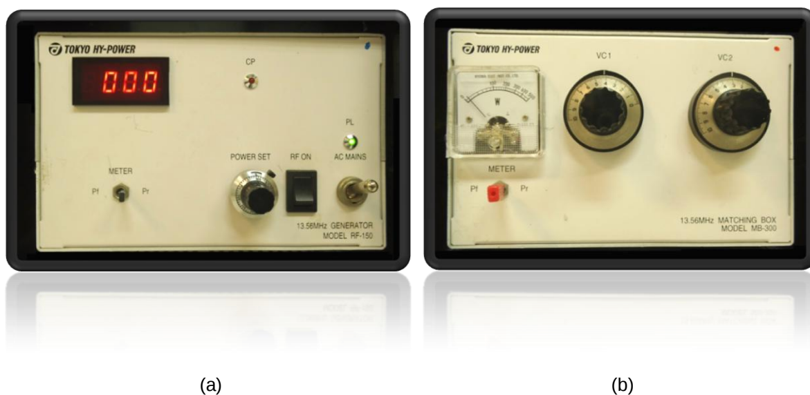
Figura 3.6 – (a) Fonte de radiofrequência responsável pela obtenção e manutenção do plasma. (b) Casador de impedância analógico responsável por minimizar a potência refletida do plasma.
