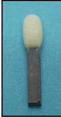
FIGURA 14 - Aspecto do Corpo de Prova após as 6 cocções da porcelana.
