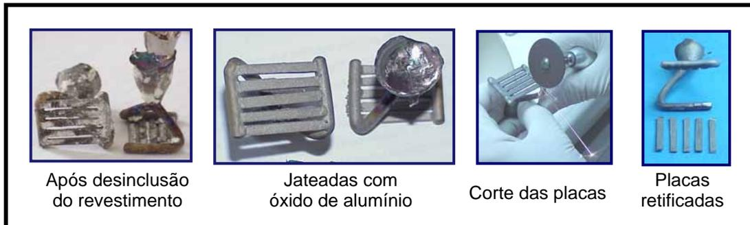
FIGURA 7 - Preparação das placas antes da aplicação da porcelana.
