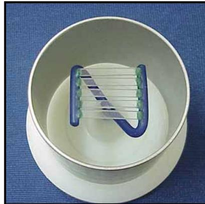
FIGURA 3 - Conjunto montado na base formadora de cadinho e anel de aço.
