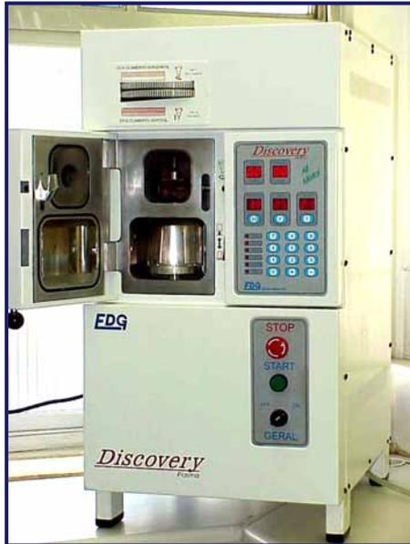
FIGURA 4 - Máquina de fundição de titânio DISCOVERY PLASMA – EDG Equipamentos.
