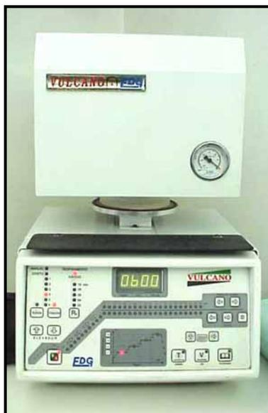
FIGURA 13 - Forno para cocção das porcelanas – Vulcano – EDG Equipamentos.
