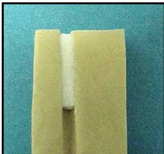
FIGURA 22 - Aplicação da porcelana em uma das partes da matriz.
