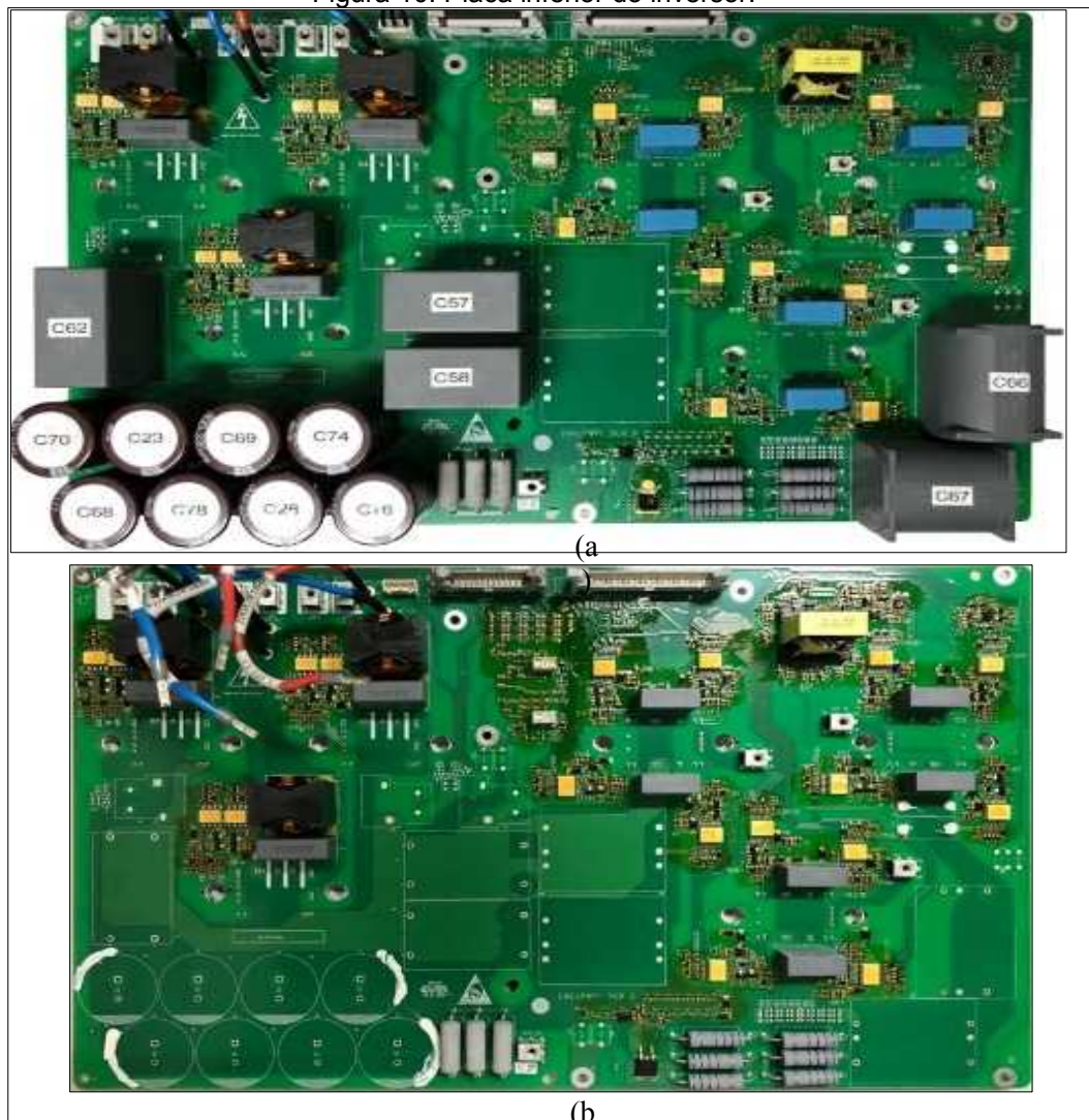
Figura 10: Placa inferior do inversor.
