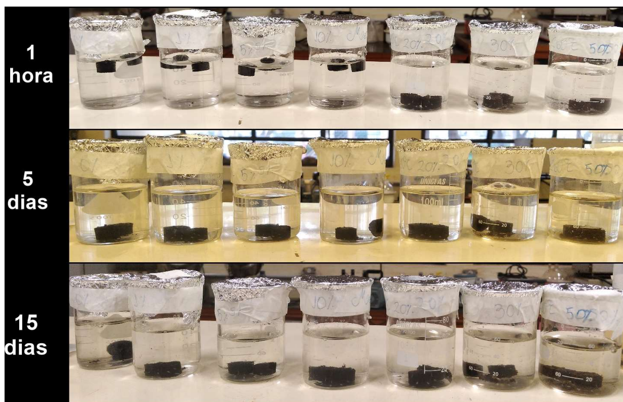
Figura 41: Ensaio de estabilidade de pellets em água de biocarvão de misturas de biomassa de pinha e argila metacaulinita torrefados a 260 °C.
