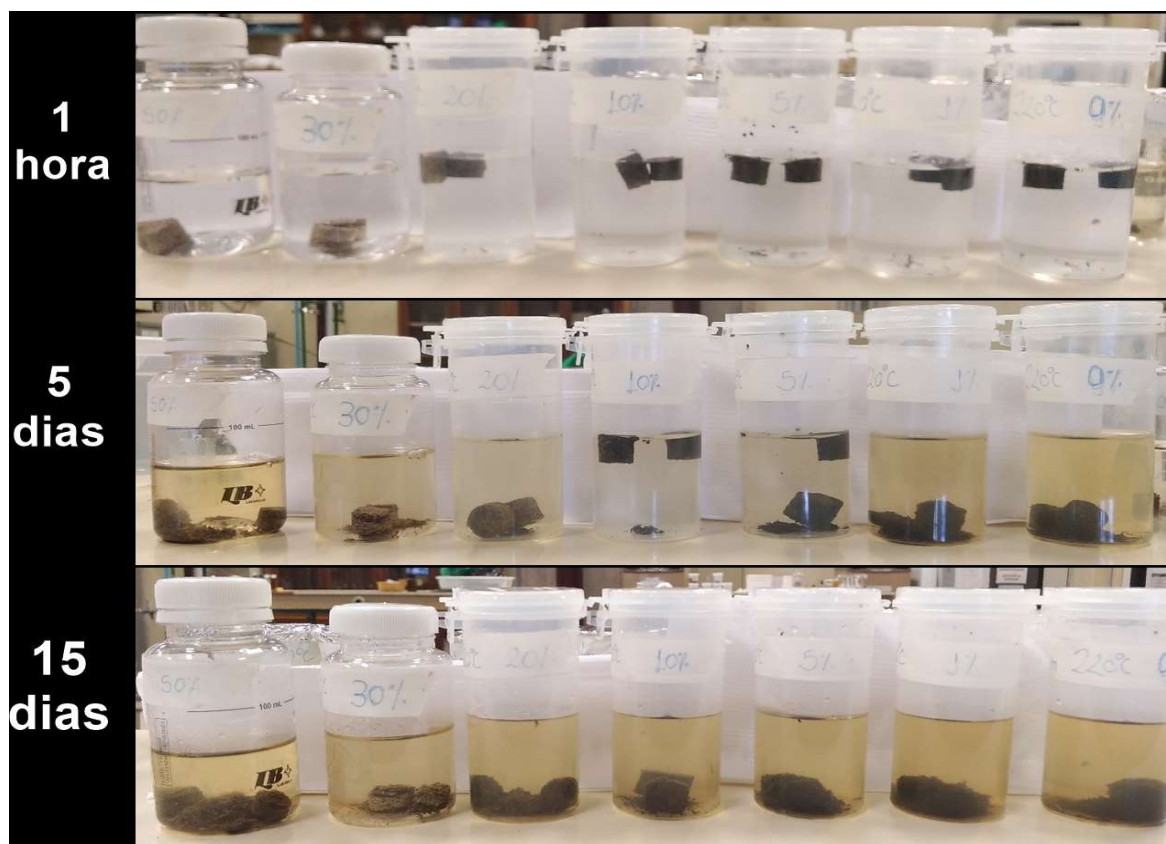
Figura 40: Ensaio de estabilidade de pellets em água de biocarvão de misturas de biomassa de pinha e argila caulinita torrefados a 220 °C.
