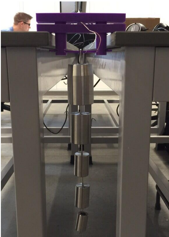
Figura 25 – Ensaio de determinação da curva resistência x força
