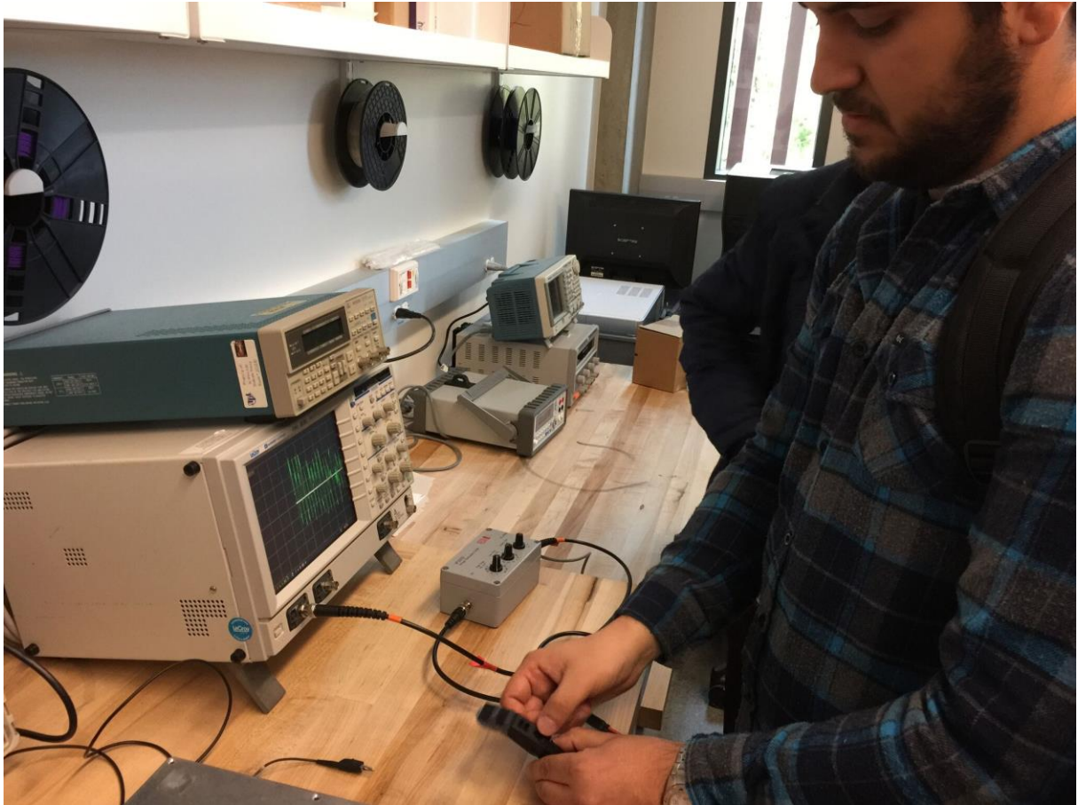
Figura 16 - Ensaio de aquisição de sinal com dedo de parede de 2 mm
