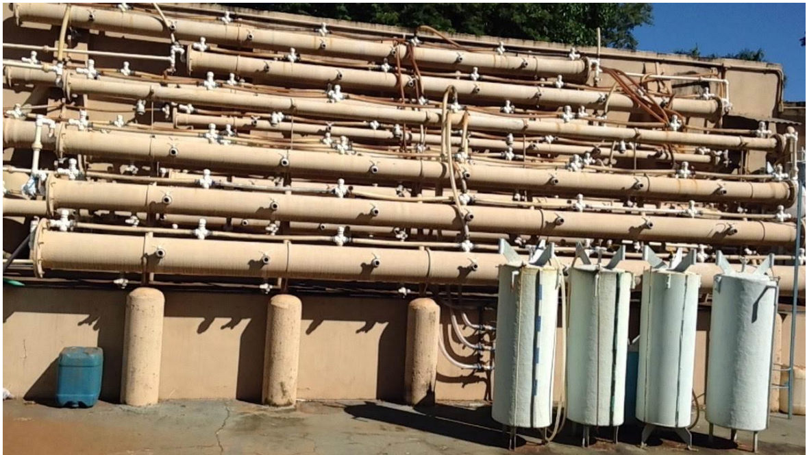
Figura 3. Foto dos RAHLF (R1, R2, R3 e R4) instalados em série e seus respectivos gasômetros
