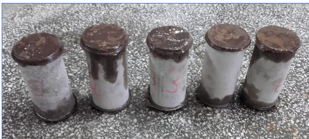
FIGURA 38 – Capeamento dos corpos de prova – IAP Cimento 28 dias
