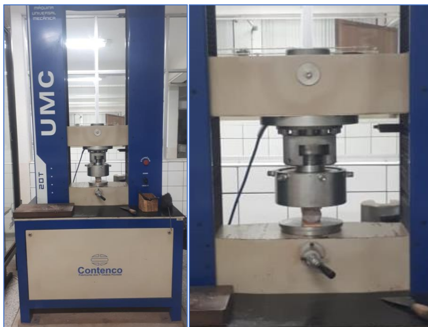
FIGURA 36 – Ensaio de resistência à tração por compressão diametral
