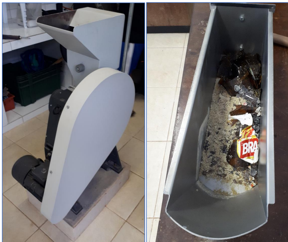
FIGURA 24 – Triturador de mandíbulas, primeira moagem do vidro
