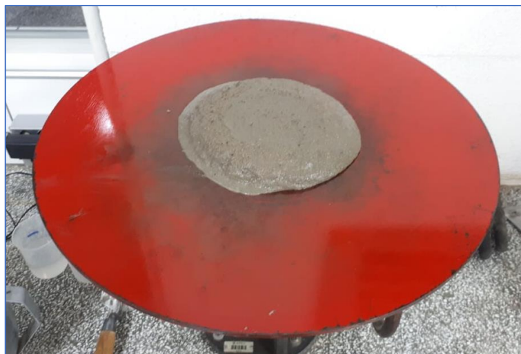
FIGURA 37 – Índice de consistência (Mesa para abatimento troncocônico)
