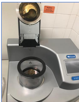
FIGURA 47 – Equipamento Sputtering Quorum para metalização
