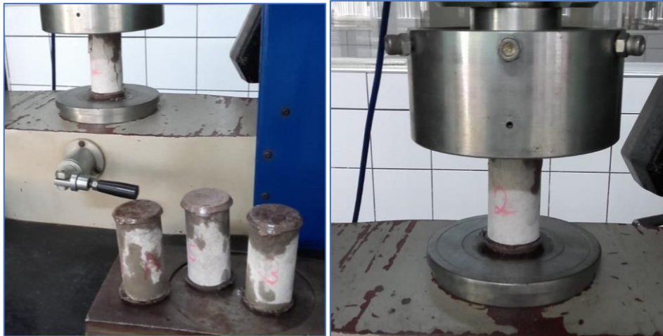
FIGURA 39 – Ensaio de compressão axial – IAP Cimento 28 dias
