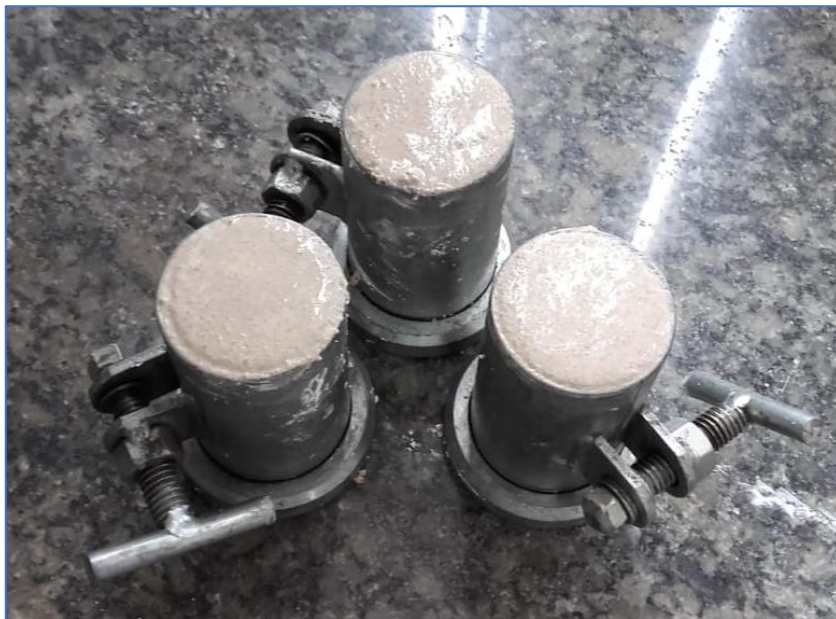
FIGURA 41 – Corpos de provas para cura térmica
