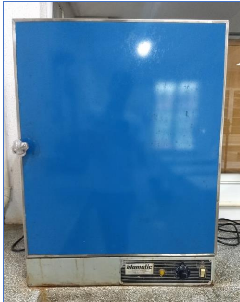
FIGURA 42 – Estufa para cura térmica dos corpos de prova em estufa
