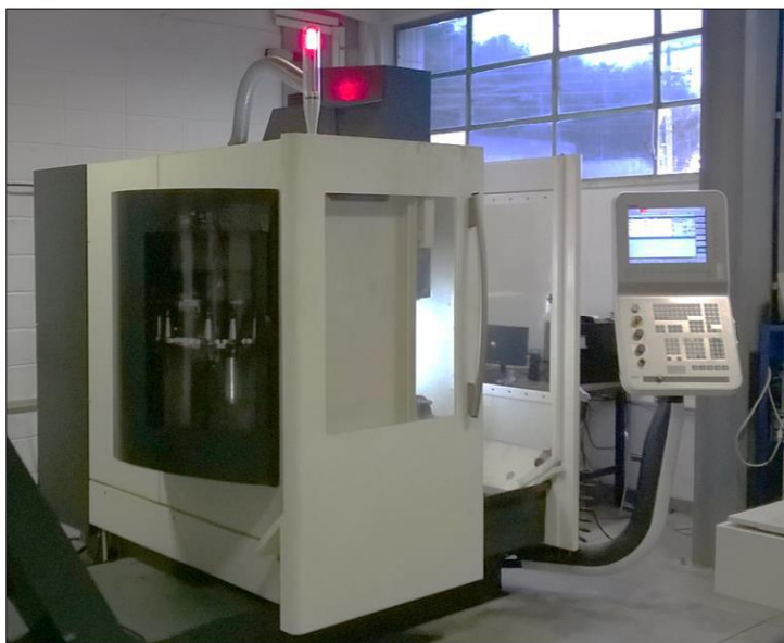
Figura 7 - Centro de usinagem marca DMG modelo DMU50ECO série Ecoline
