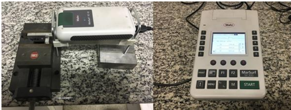
Figura 16 - Rugosímetro da marca Mahr e modelo MarSurf M 300
