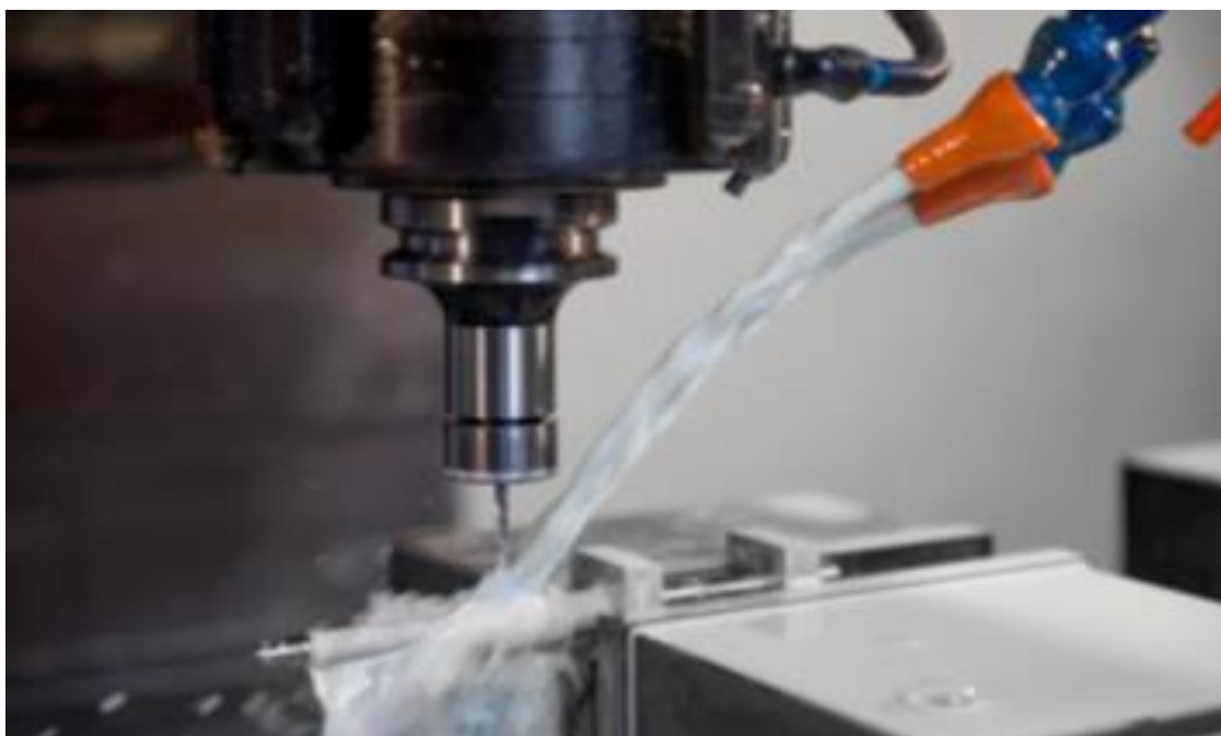
Figura 3 - Jato de fluido a baixa pressão no processo de furação
