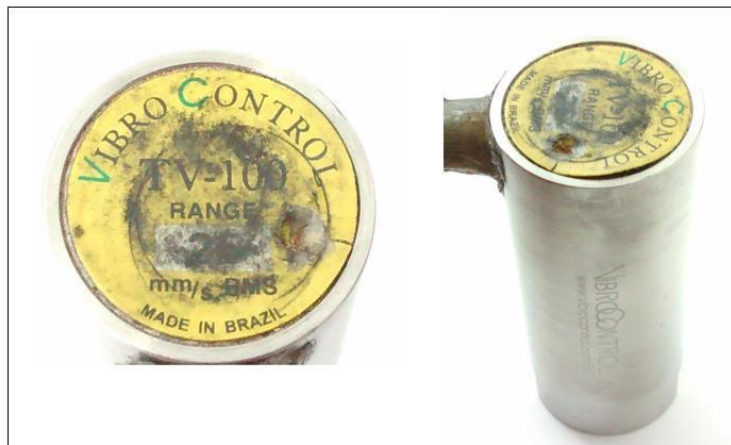
Figura 11 - Sensor piezelétrico da marca Vibro Control , modelo TV100
