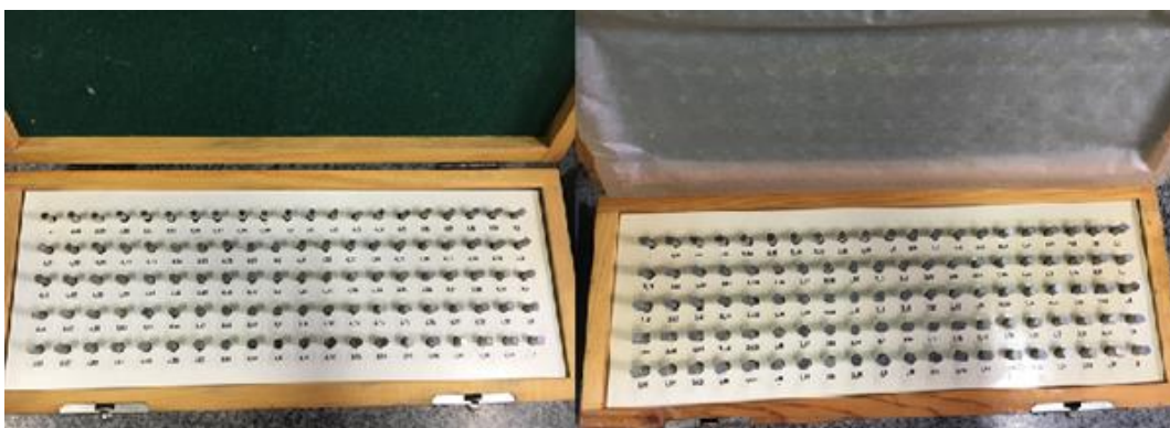
Figura 15 - Conjunto de pinos padrão da marca VEB LANGENMESSTECHNIK - LIMBACH, 4-5/0,01 e 5-6/0,01
