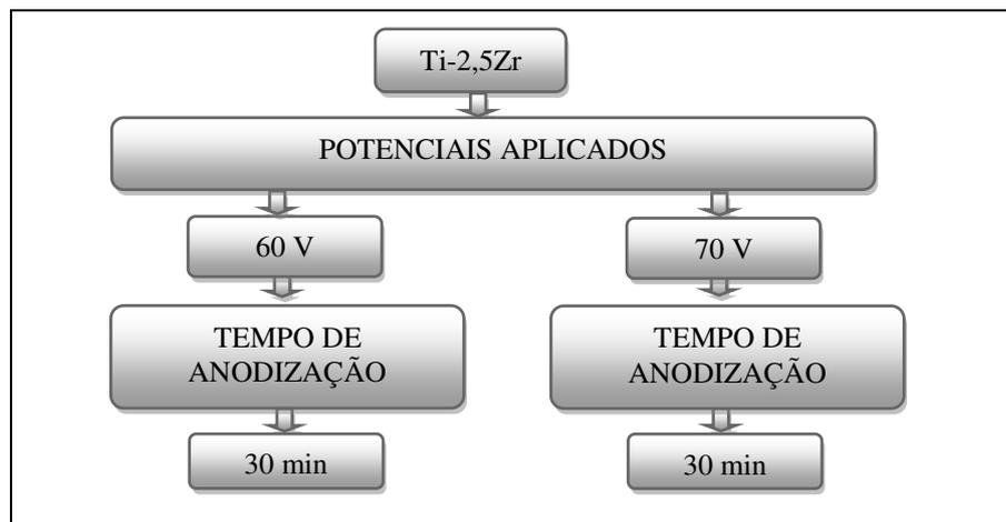
**Figura 10 - Fluxograma da anodização da amostra de Ti-2,5Zr.**
