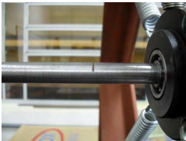
Figura 52 - Entalhe com profundidade de 40% do diâmetro do eixo, na região correspondente ao elemento 1 do modelo.
