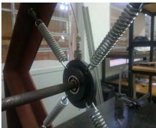
Figura 45 – Acelerômetros acoplados nos mancais 1 (a) e 2 (b).
