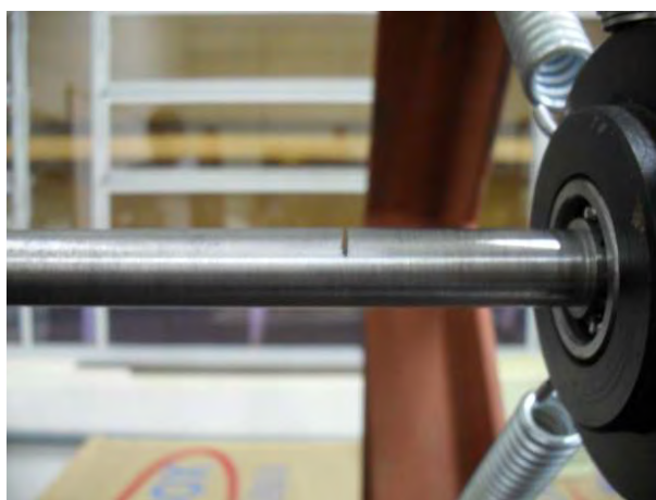
Figura 48 –Entalhe com profundidade de 30% do diâmetro do eixo, na região correspondente ao elemento 1 do modelo.
