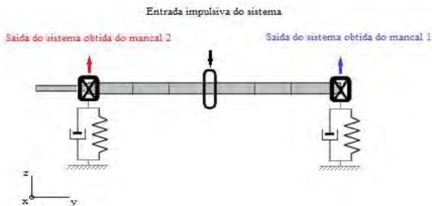
Figura 67 - Entrada e saídas do sistema em análise transiente para obtenção das respostas no domínio da frequência, no plano z-y.
