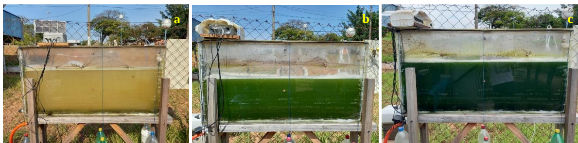
Figura 3-1: Aspecto do efluente do dia 7 em uma batelada da L1 (a) e duas bateladas da L2 (b e c) no tratamento do FBR-FP
