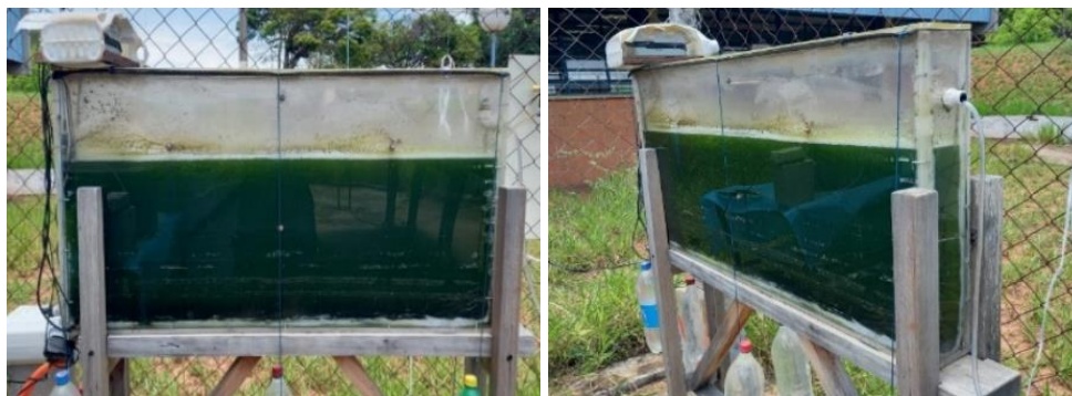
Figura 1-3: FBR-FP em escala piloto utilizado no estudo
