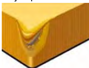
Figura 11 - Deformação plástica na ferramenta de corte.
