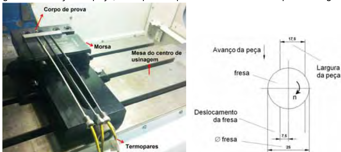
Figura 34 - Fixação da peça, termopares e posicionamento da fresa para usinagem.
