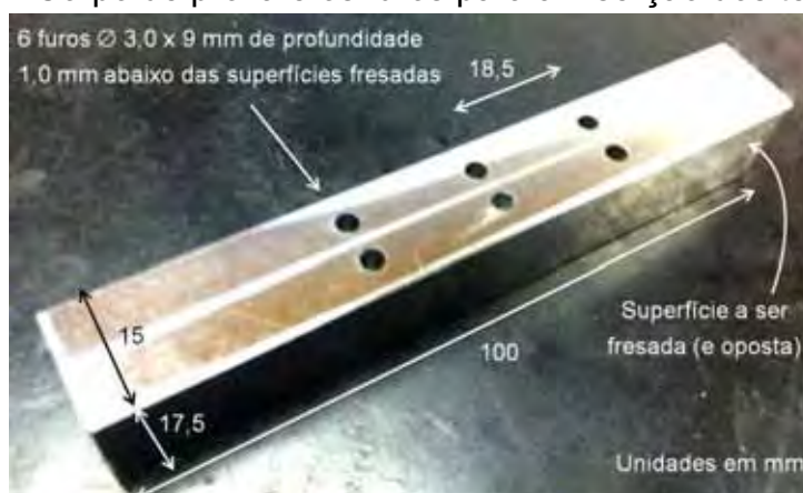
Figura 32 - Corpo de prova e os furos para a inserção dos termopares.
