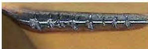
Figura 12 - Trincas térmicas na ferramenta de corte.
