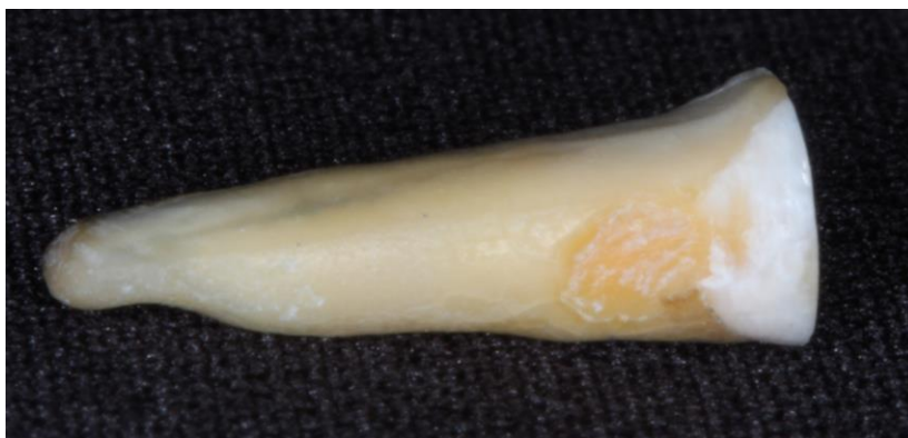
Figura 8 – Espécime preparado com desgaste proximal externo para a exposição dentinária e leitura do pH.
