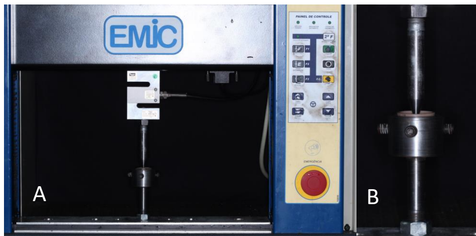
Figura 5 – Em (A) máquina de ensaios mecânicos EMIC, em (B), suporte metálico e pino para fratura.
