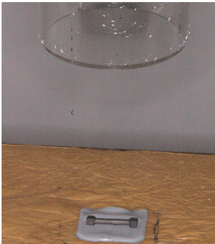
Fig. 21 - Posição do conjunto: sensor de fosforo ativado, corpo de prova e cilindro localizador.
