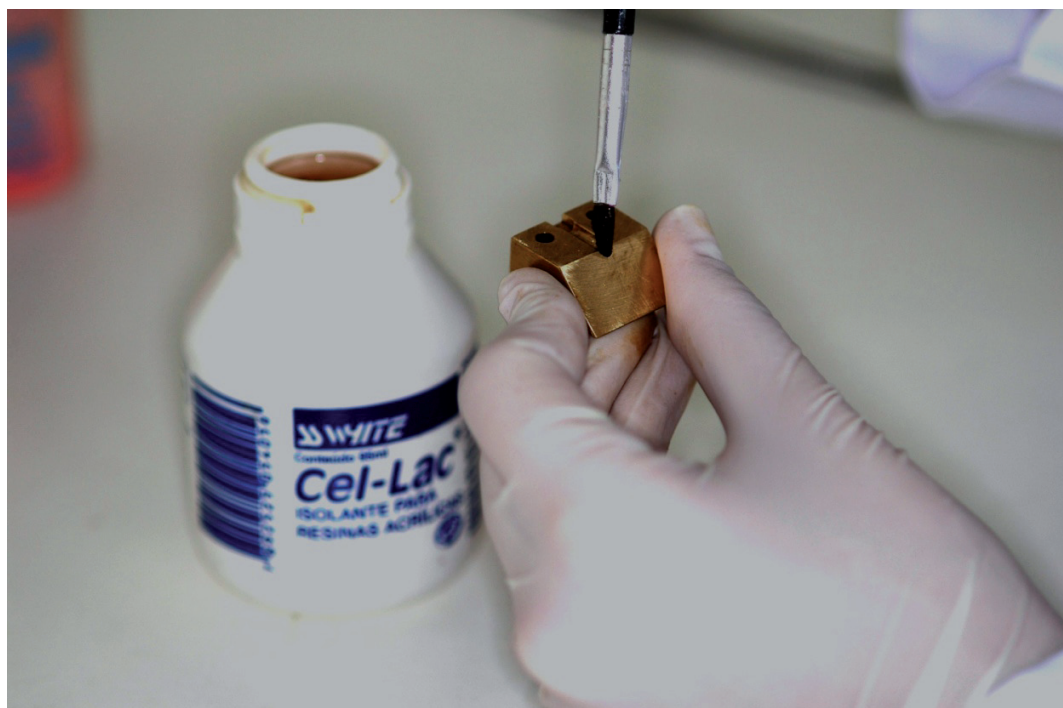
Fig. 10 – Aplicação do isolante para resinas acrílicas na superfície dos moldes metálicos.
