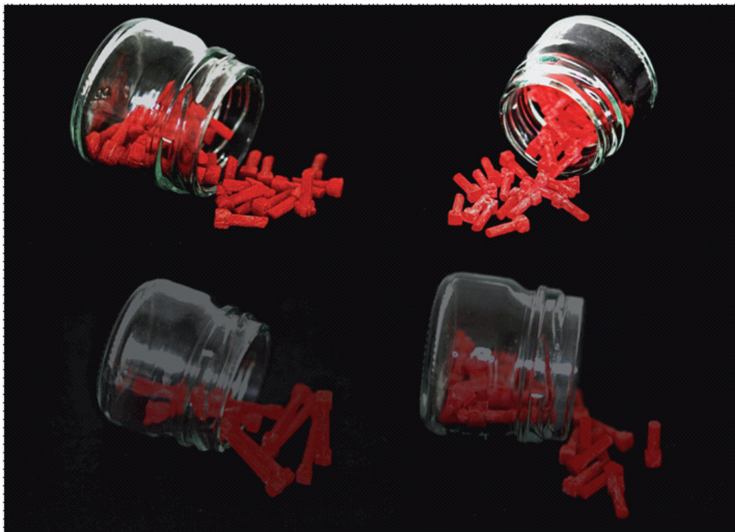
Fig. 12 - Padrões em resina acrílica organizados em grupo de acordo com a sua angulação ou ausência de secção (Ctrl).
