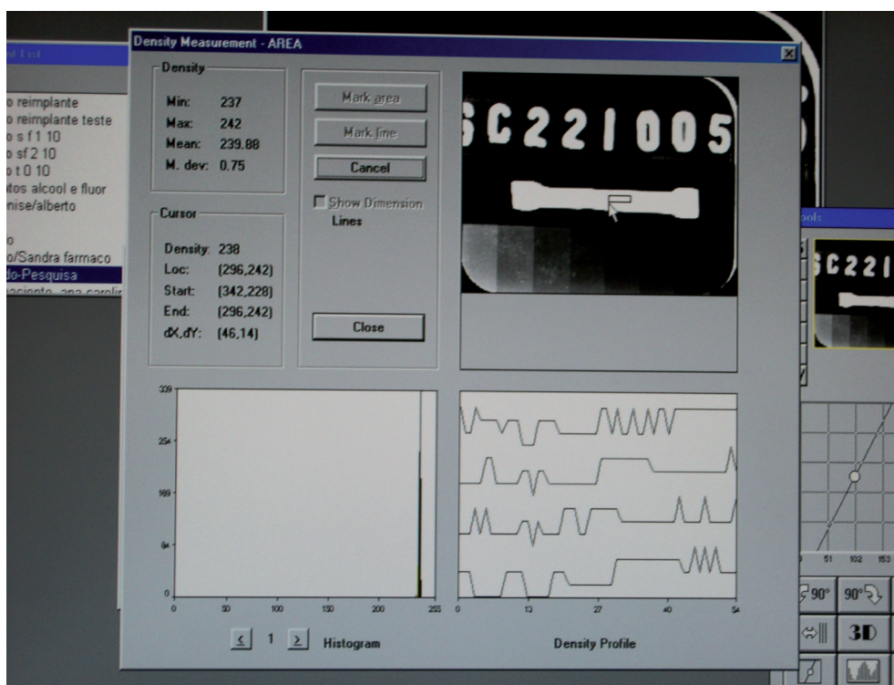
Fig. 23 - Aferimento da média da densidade óptica na região da solda..
