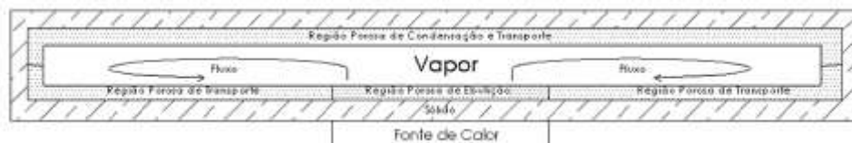
Figura 42- Esquema de funcionamento da vapor chamber .
