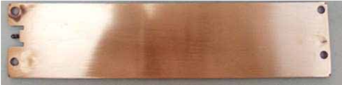
Figura 27 - Vapor chamber utilizada no experimento.
