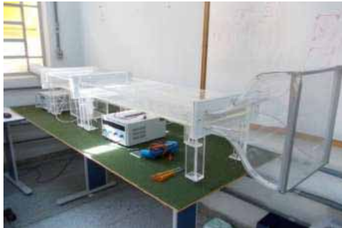
Figura 56 - Túnel de vento.
