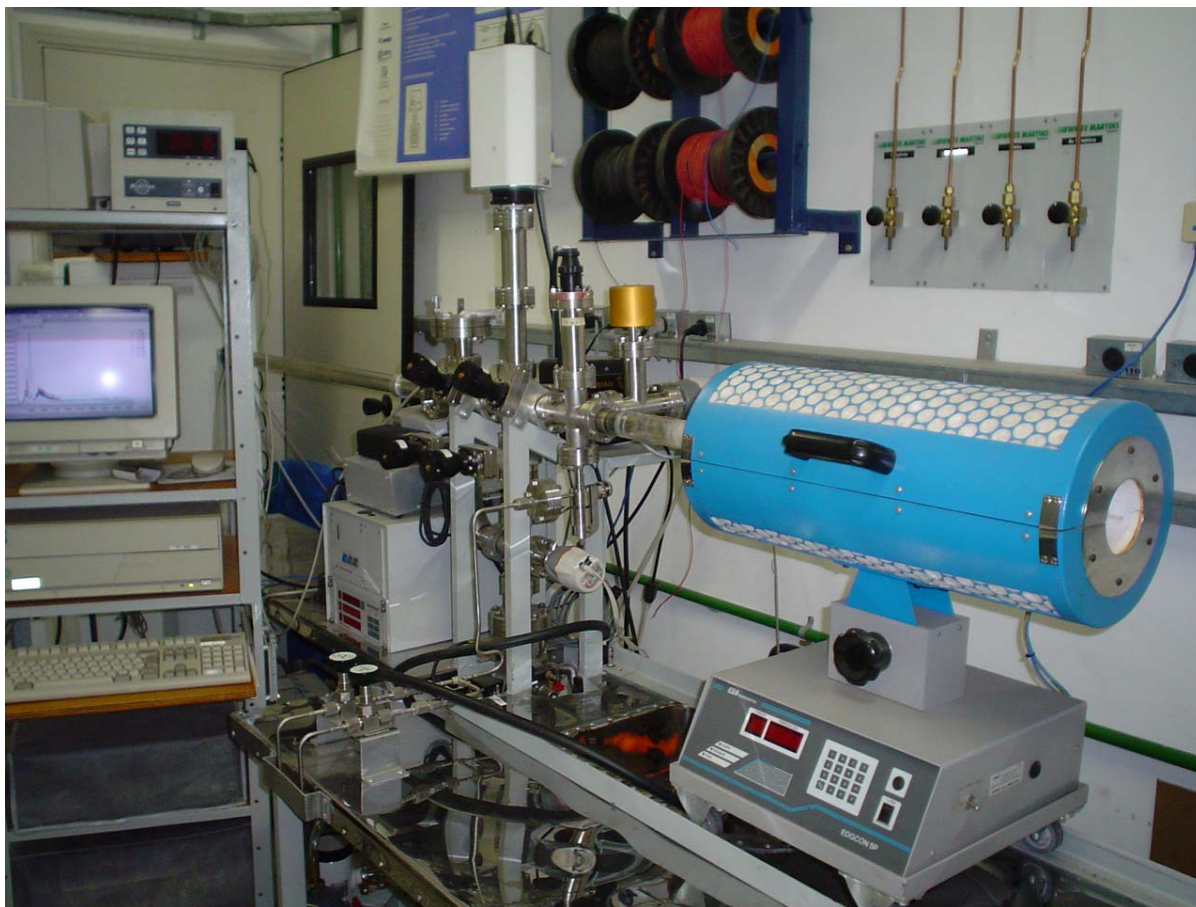
Figura 32 – Fotografia do sistema de dopagem e tratamento térmico.
