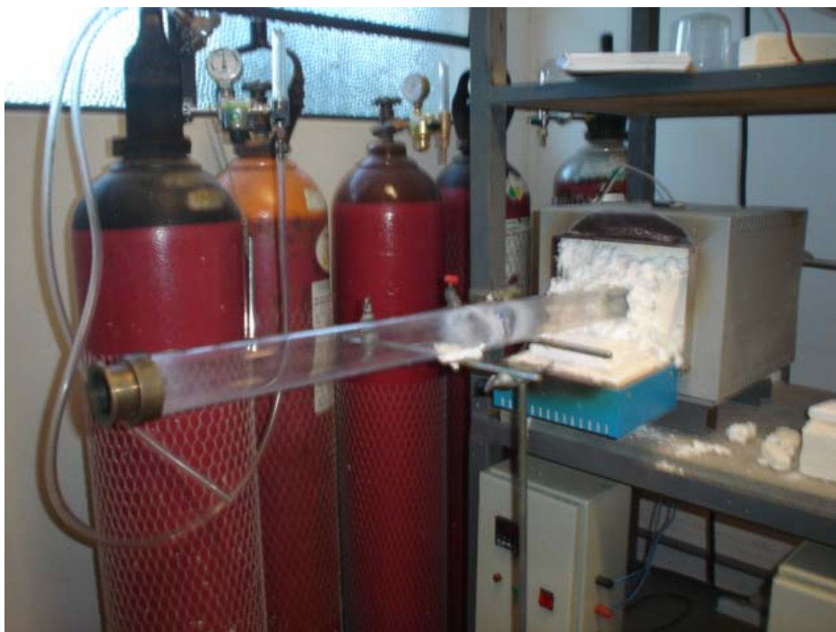
Figura 7 – Fotografia do forno da UEPG utilizado na preparação das amostras de Ru-1212. Atrás estão os cilindros de nitrogênio e oxigênio utilizados para manter o fluxo de gás durante os tratamentos.
