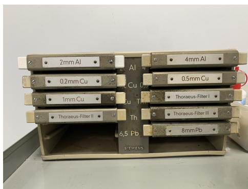
Figura 10 – Caixa de armazenamento dos diferentes filtros do Stabilipan II
