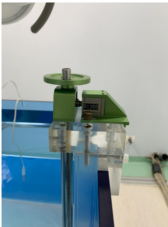
Figura 15 – Micrômetro manual usado para controlar a profundidade da câmara
