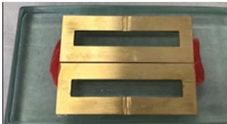
Figura 10- Matriz metálica retangular posicionada sobre a placa de vidro
