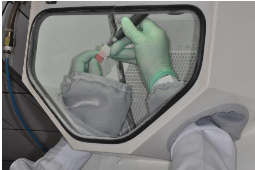
Figura 13- Jateamento com óxido de alumínio ( \text{Al}_2\text{O}_3 ) 50 \mu\text{m}
