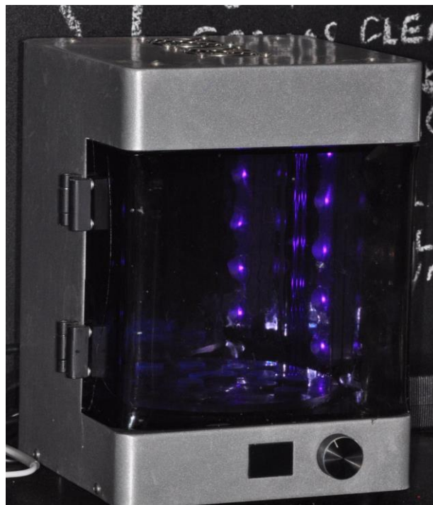
Figura 6- Equipamento Form Cure para polimerização adicional em luz UV
