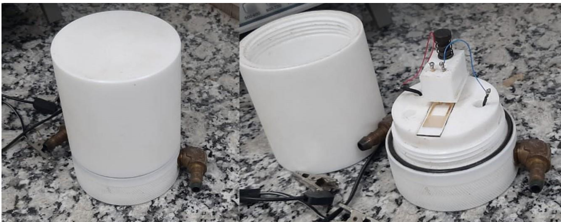
Figura 12. Porta amostras utilizado nas medidas elétricas.
