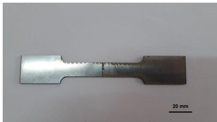
Figura 19 – Obtenção das amostras das chapas soldadas para ensaio de tração.
