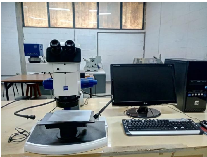
Figura 23 – Microscópio Zeiss, modelo Discovery V8.
