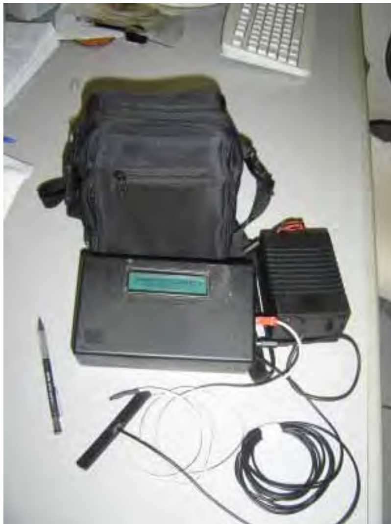
Figura 5.2 Foto do Sistema de Telemetria montado e acondicionado em uma mochila para transporte
