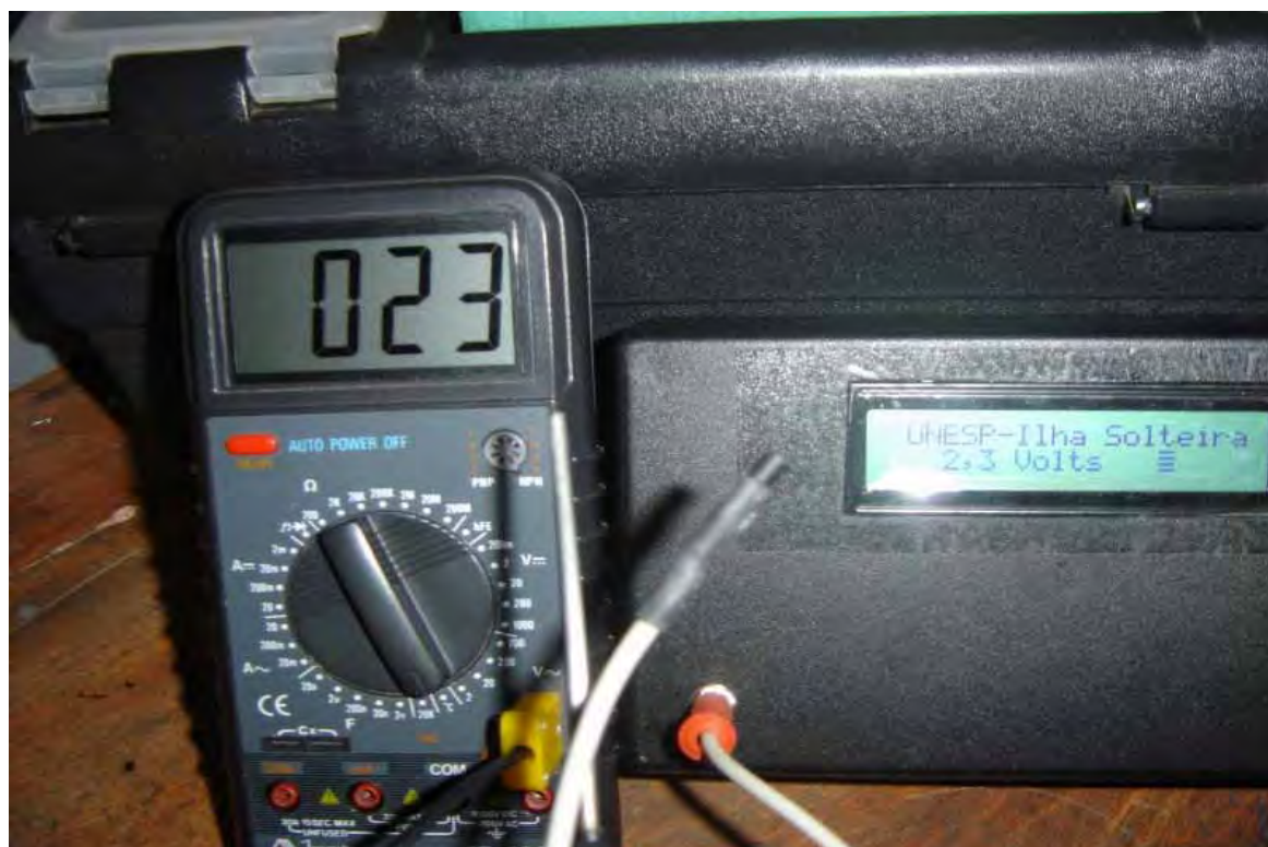
Figura 5.0 - Foto mostrando os valores Temperatura no Multímetro e Tensão do Sistema de Monitoração
