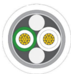
Figura 14 – Cabo blindado duplo com seção transversal em formato circular.
