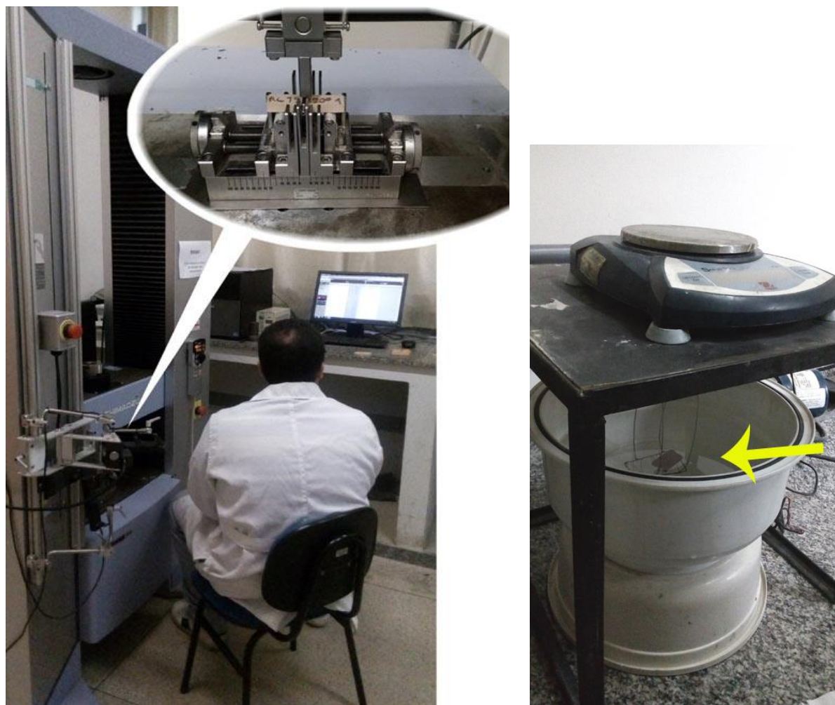
Figura 38: à esquerda: Equipamento (Flexora Shimadzu AG-X) utilizado para realização de teste de flexão. À direita: balança de precisão para determinação de porosidade aparente e absorção de água nos corpos de prova. Seta amarela indicando corpo de prova submerso. São João Del Rei, 2016.
