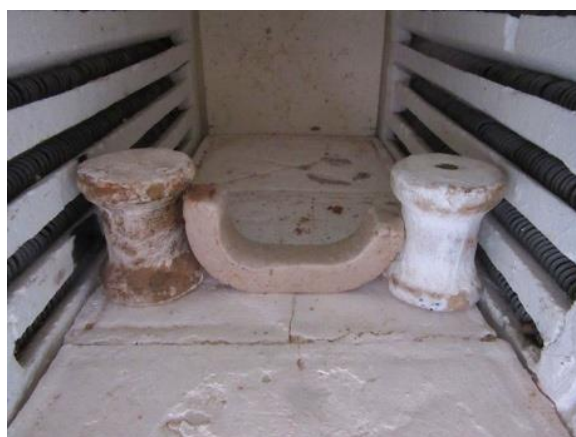
Figura 31: À esquerda, barra pirométrica Condorhuasi para temperatura de 1205°C, montada em forno de testes, à direita, seu estado após a queima. Laboratório Escola de Cerâmica –UFSJ, 2016.
