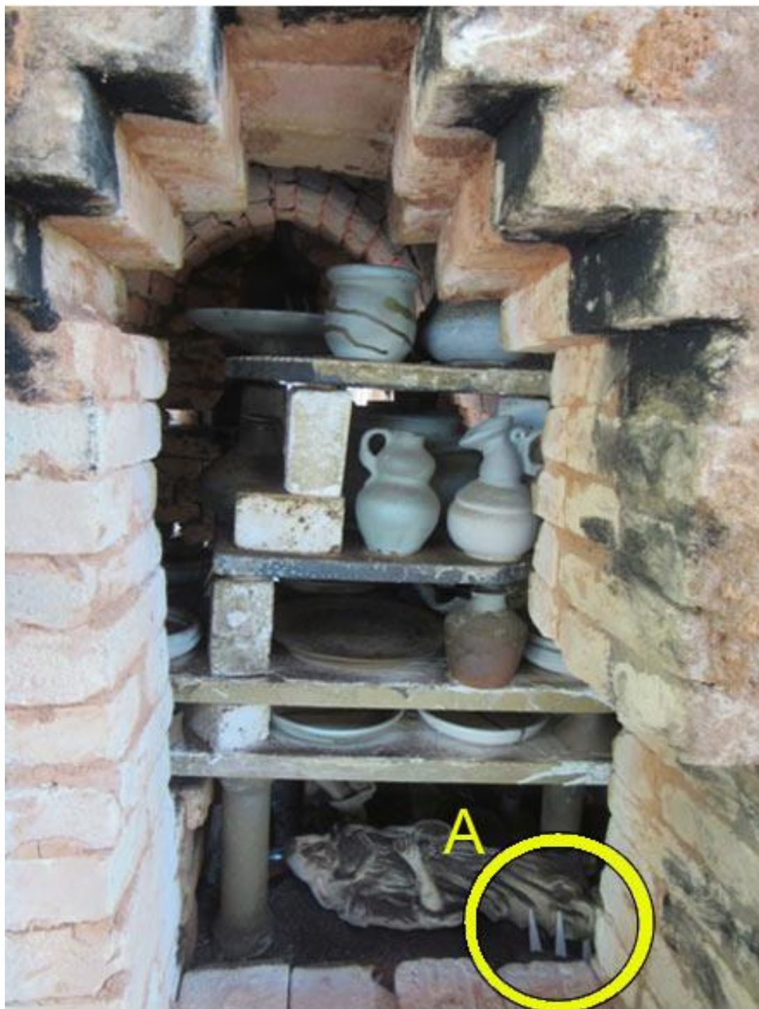
Figura 79: Vista do interior do forno catenário com as peças já queimadas, evidenciando as temperaturas atingidas. Círculo A, cones 1220°C, 1240°C, 1260°C. Resende Costa, MG, 2016.
