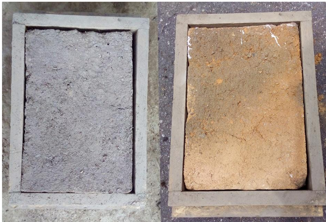
Figura 55: Tijolo dupla face conformado: à esquerda, seco; à direita, já queimado. Ritápolis, 2016.
