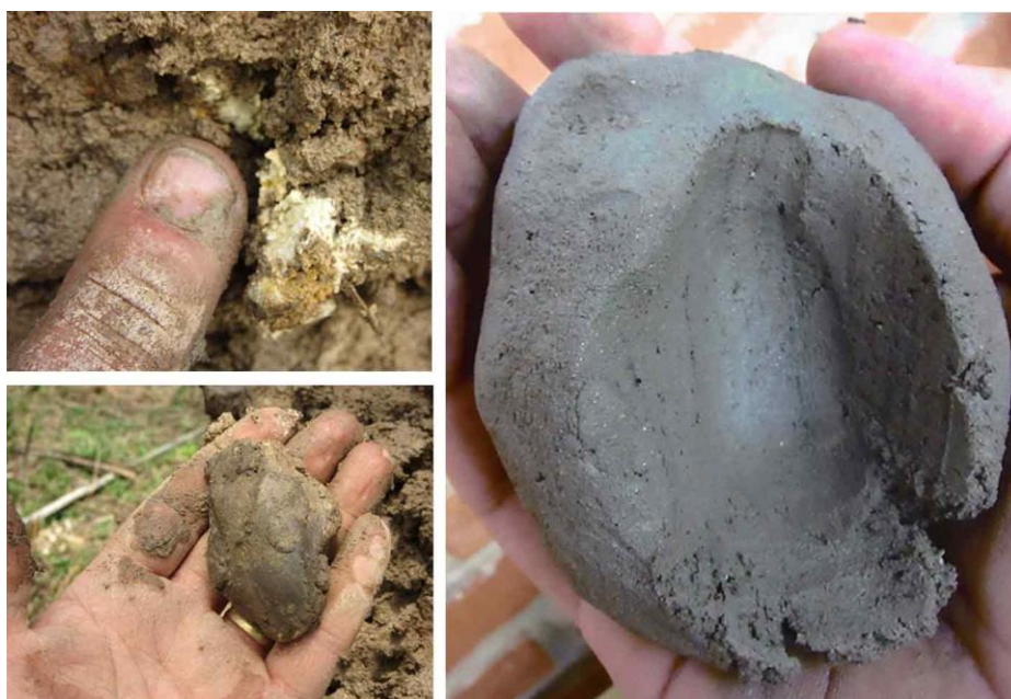
Figura 46: à esquerda superior: amostra de massa preparada em olaria, com destaque para área onde o caulim não se integrou perfeitamente à mistura; à esquerda abaixo: grumo de argila, presente na massa; à direita: massa preparada em laboratório: perfeitamente homogeneizada.
