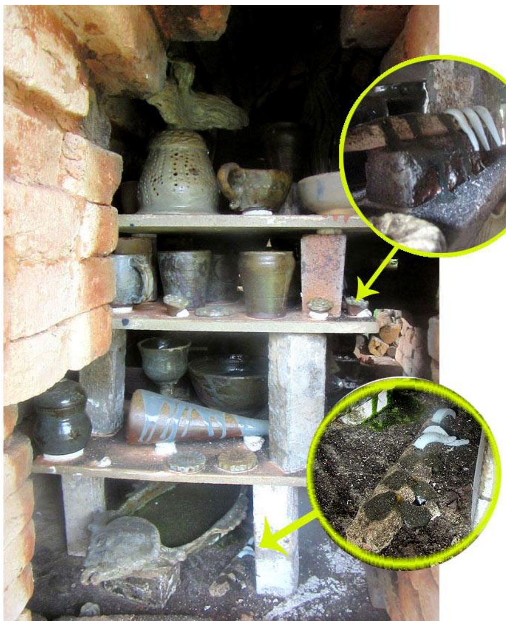
Figura 87: Imagem de uma das aberturas laterais do forno, com detalhe para os conjuntos de cones fundidos. Resende Costa, 2016.
