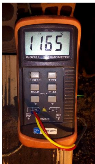
Figura 110: Termopar registrando 1165°C de temperatura. Ritápolis, 2016
