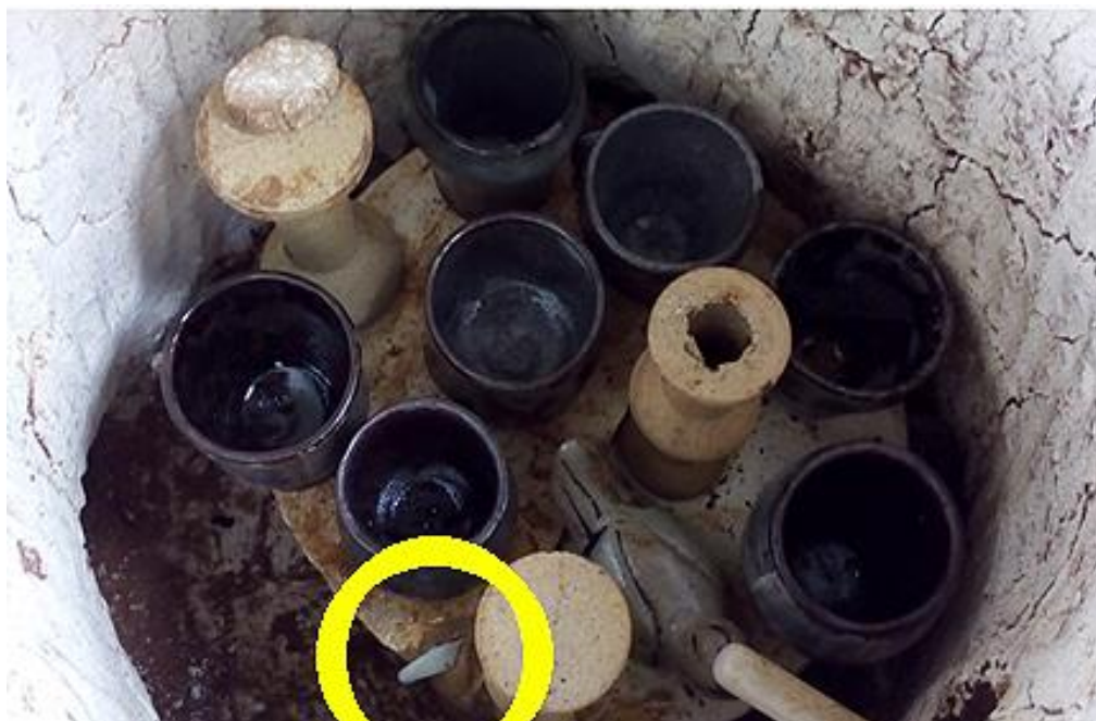
Figura 114: Queima 3. Vista superior da prateleira inferior montada em forno Tamborigama. Peças com esmalte fundido e no detalhe o cone referente à temperatura de 1220°C tombado. Ritápolis, 2016.
