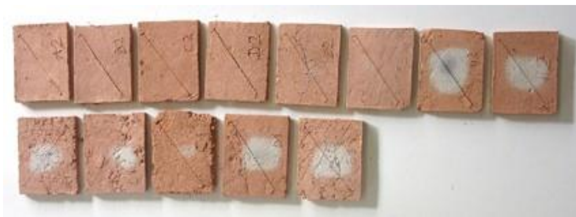
Figura 41: exemplo de corpos de prova para teste de retração.
