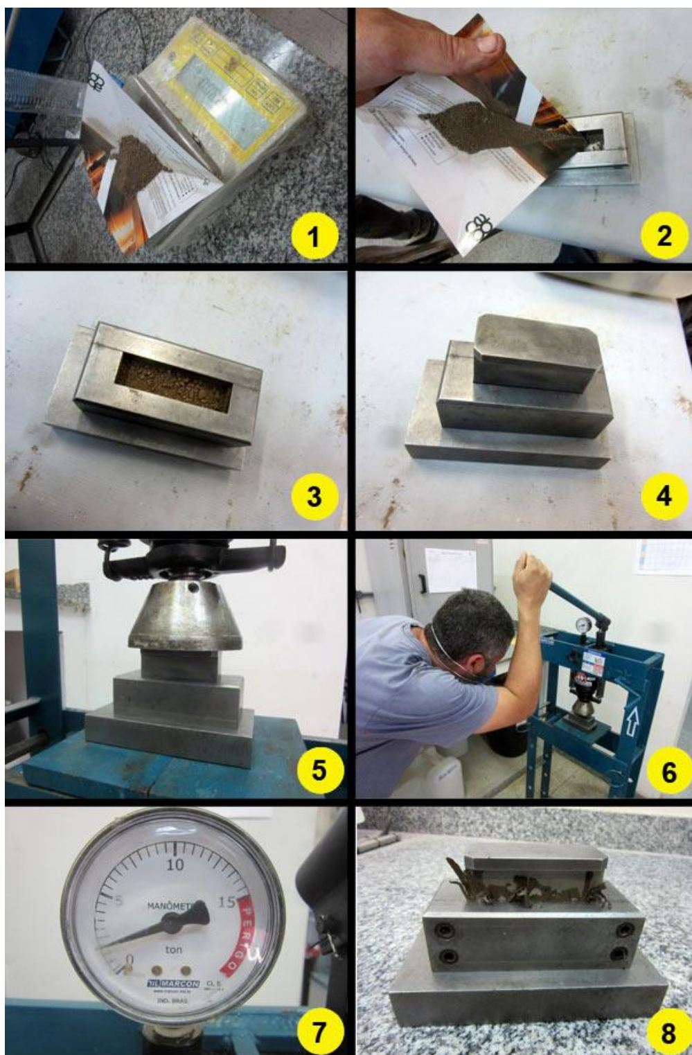
Figura 39: Preparação das amostras de argilas a serem conformadas. 1) aferição de peso 2) preenchimento do molde 3) molde preenchido 4) inserção do pistão sobre a massa 5) molde preparado para conformação 6) conformação em prensa hidráulica 7) pressão empregada 8) molde pressionado, rebarbas de argila umedecida a 25%.
