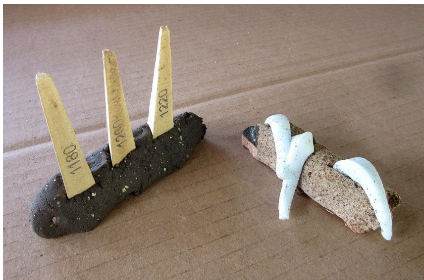
Figura 29: À esquerda: cones crus, prontos para irem ao forno, à direita: cones já fundidos. 2016
