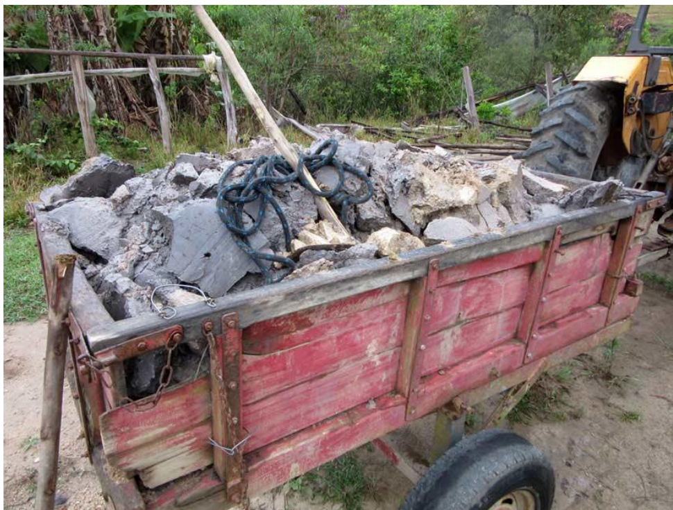
Figura 45: Carroça: Sistema de medição de volume utilizado na olaria para preparação dos corpos de prova de massas refratárias e isolante.
