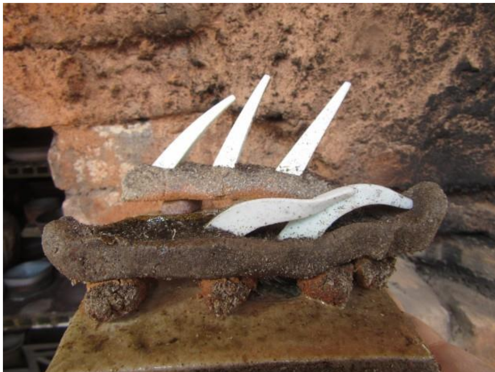
Figura 80: Detalhe de cones pirométricos. Frente: cones da esquerda para direita: 1100°C (completamente fundido), 1220°C, 1240°C (perfeitamente tombados), atrás cones: 1260°C (com indicativo de fusão), 1280°C, 1300°C. Resende Costa, 2016.
