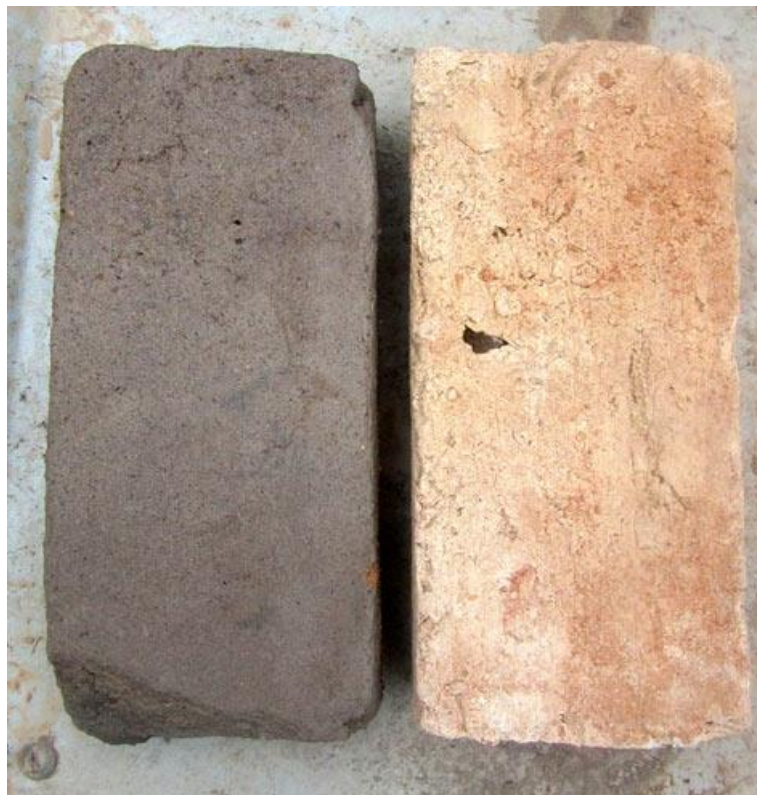
Figura 68: Exemplo de falta de padronização nos tijolos artesanais. O tijolo da esquerda está praticamente cru, enquanto o da direita apresenta irregularidades nas laterais, Resende Costa, 2016.
