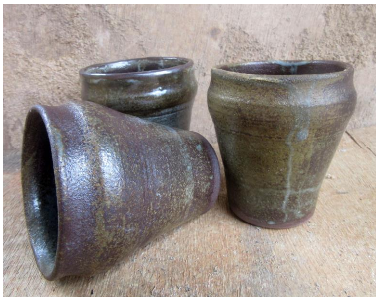
Figura 112: Peça com esmalte parcialmente fundido. Segunda queima em forno Tamborigama.
