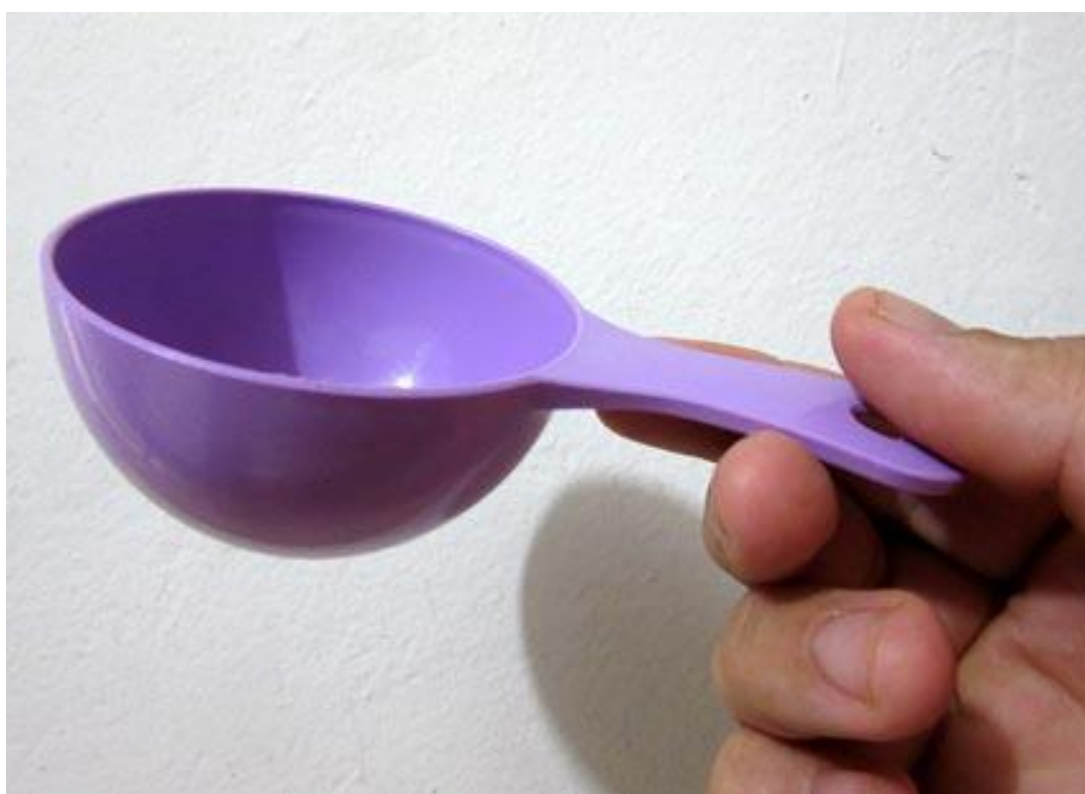
Figura 44: Sistema de medição de volume utilizado em laboratório, para preparação dos corpos de prova de massas refratárias e isolante. Laboratório Escola de Cerâmica – UFSJ, 2016.
