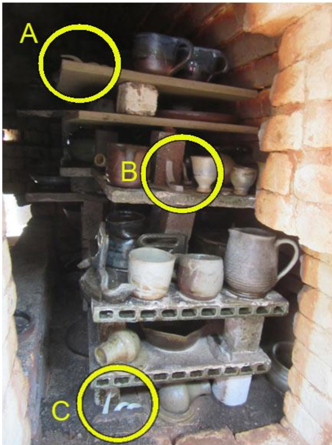
Figura 83: Vista das peças, a partir de uma das portas do forno, após segunda queima. Círculo A, cones: 1220°C, 1240°C, 1260°C, círculo B: barra pirométrica para 1240°C, círculo C, cones: 1200°C, 1220°C, 1240°C. Resende Costa, 2016.
