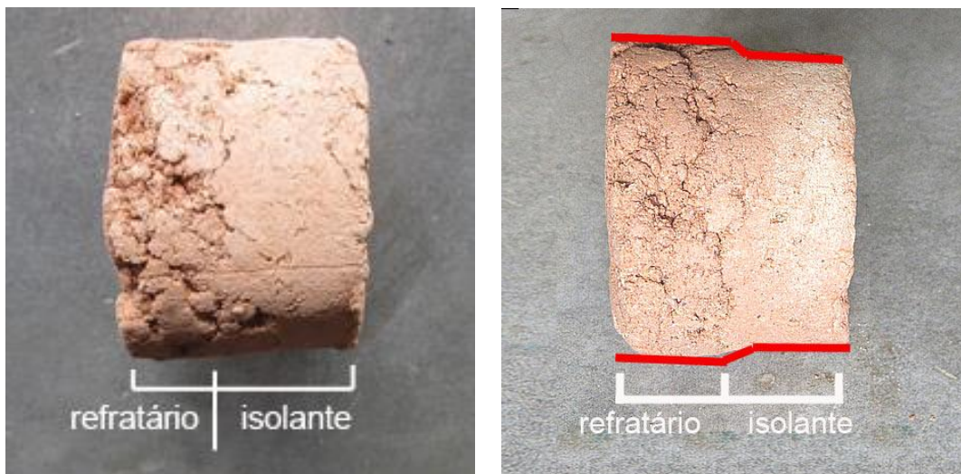
Figura 52: à esquerda: corpo de prova de tijolo dupla face, preparado com massas B2 e B6, queimado a 800°C. à direita: corpo de prova com mesma composição, queimado a 1200°C. Laboratório Escola de Cerâmica –UFSJ, 2015.
