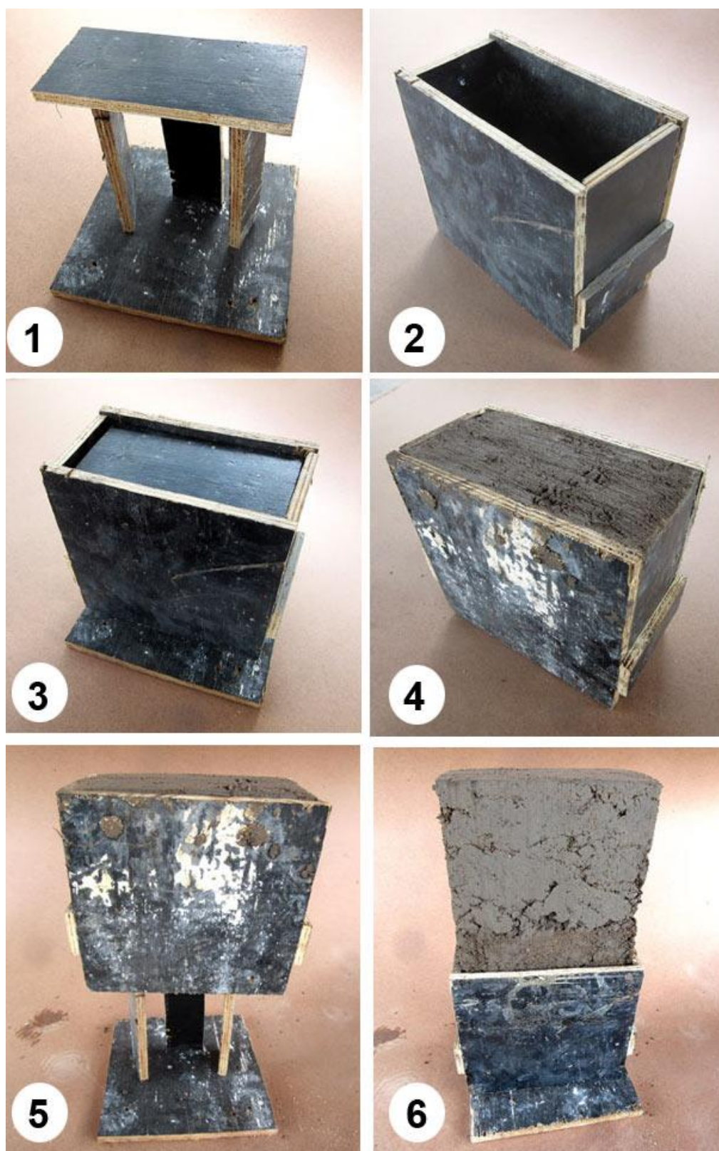
Figura 53: Etapas do processamento manual da fabricação de um tijolo dupla face. Laboratório Escola de Cerâmica – UFSJ, 2015.
