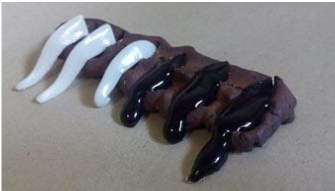
Figura 111: cones: da direita para a esquerda = 1120°C, 1140°C, 1160°C, 1180°C, 1200°C, 1220°C. Percebe-se que os dois últimos cones estão caídos devido à má conformação da base de sustentação, no entanto percebe-se igualmente terem se deformado, indicando ter a temperatura da queima chegado a pelo menos 1200°C.
