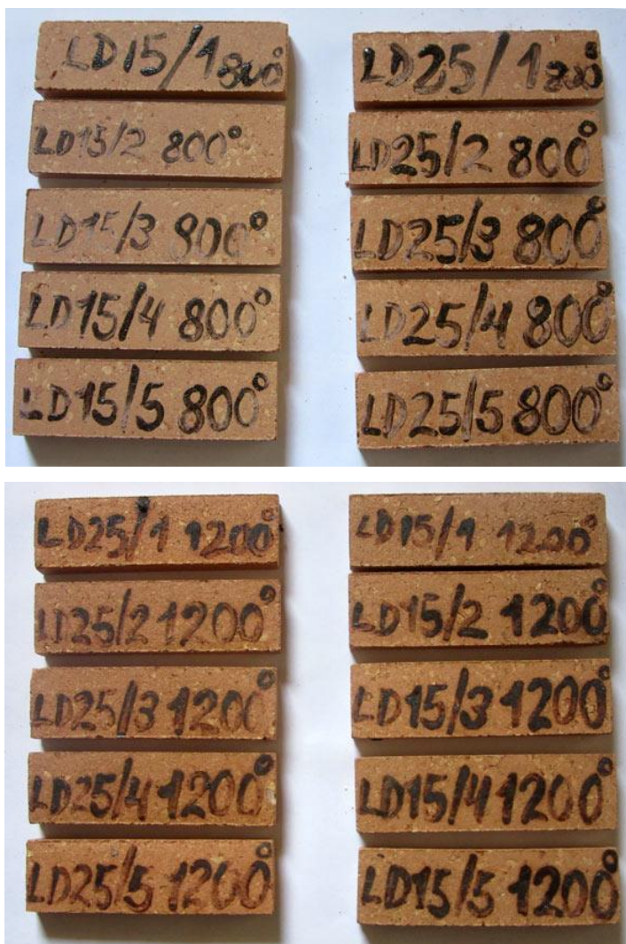
Figura 36: Corpos de prova queimados a 800°C e 1200°C, argila LD.
