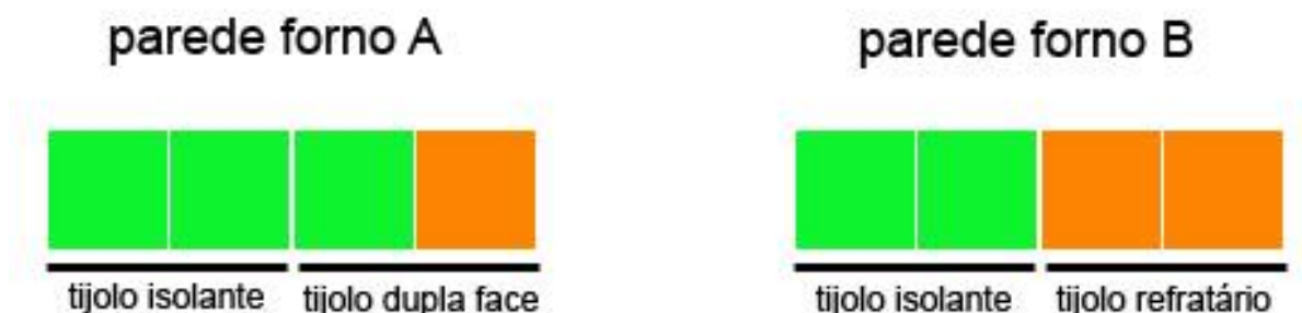
Figura 51: Comparativo entre duas possibilidades de construção de paredes de fornos.
