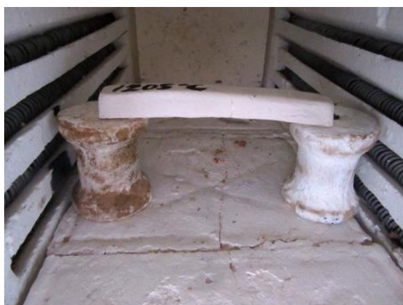
Figura 31: À esquerda, barra pirométrica Condorhuasi para temperatura de 1205°C, montada em forno de testes, à direita, seu estado após a queima. Laboratório Escola de Cerâmica –UFSJ, 2016.
