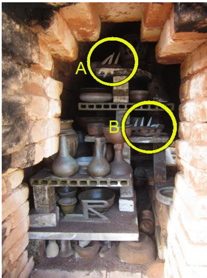
Figura 78: Vista do interior do forno catenário com as peças já queimadas, evidenciando as temperaturas atingidas. Círculo A, cones 1260°C, 1280°C 1300°C, círculo B, cones 1100°C, 1220°C, 1240°C, 1260°C, 1280°C, 1300°C, Resende Costa, MG, 2016.
