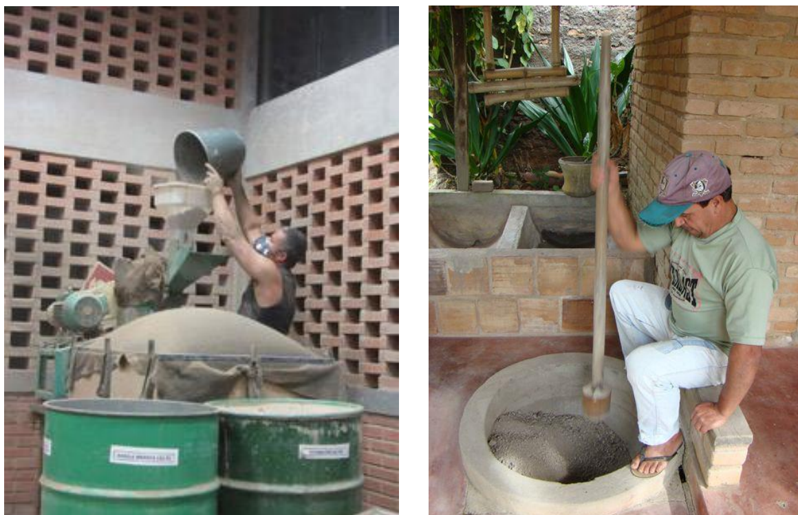
Figura 61: A esquerda: processamento da argila, de forma mecânica. Laboratório Escola de Cerâmica – UFSJ, 2016, à direita, processamento manual, Cunha – SP, 2010.
