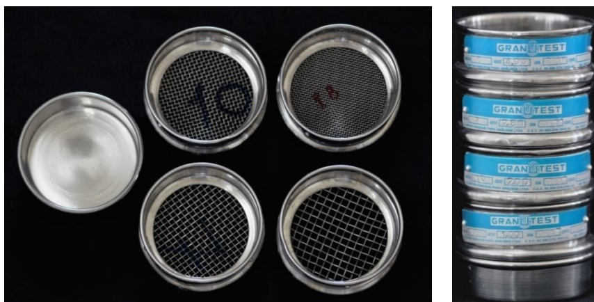
Figura 9- Sistema de tamises
