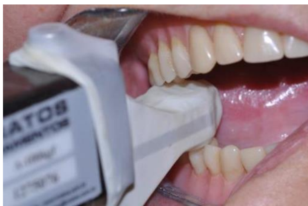
Figura 8- Equipamento posicionado na região de primeiros molares para mensuração da máxima força de mordida oclusal
