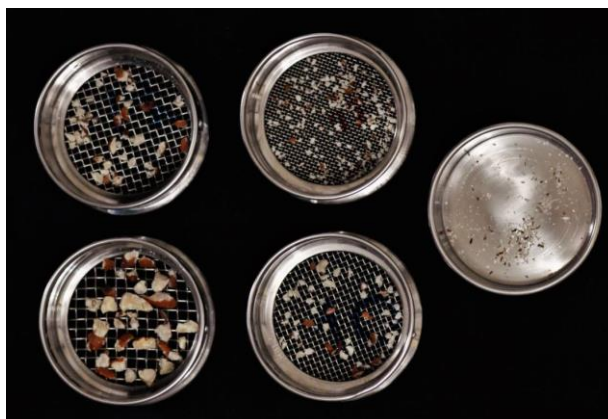
Figura 10- Partículas de amêndoas retidas em diferentes tamanhos de orifícios, após tamisação
