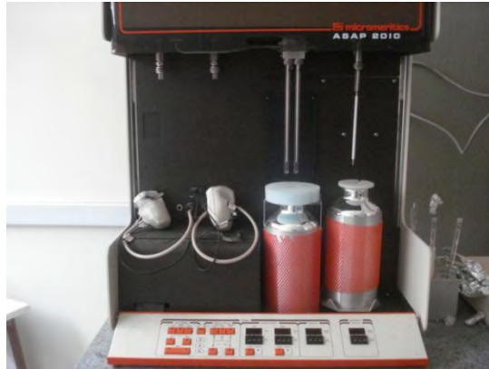
Figura 3. 16: Foto ilustrativa do aparelho utilizado nas análises de adsorção de nitrogênio.
