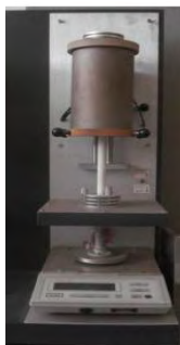
Figura 3. 4: Imagem do forno acoplado à balança, utilizado para análise termogravimétrica dos géis úmidos.
