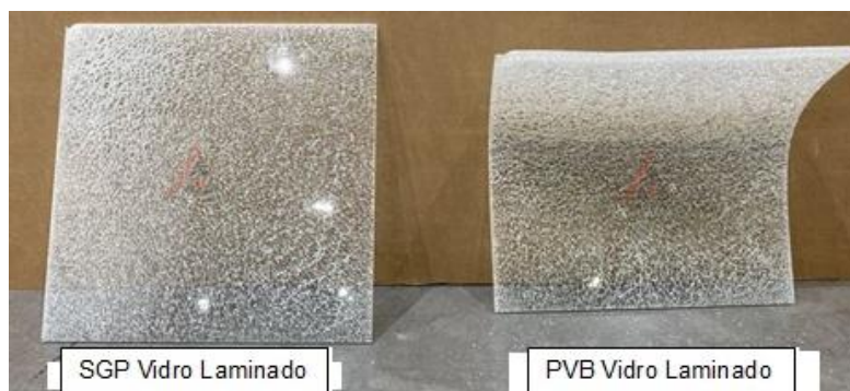
Figura 4 – Comparação visual entre SGP e PVB
