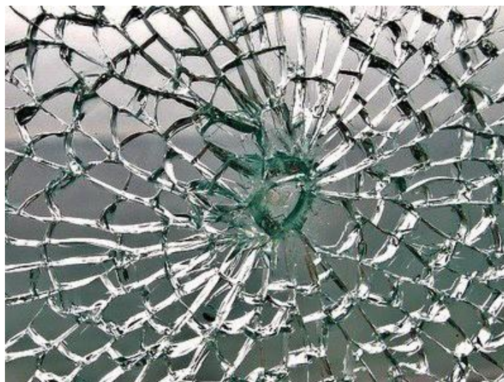
Figura 1 – Quebra do vidro temperado
