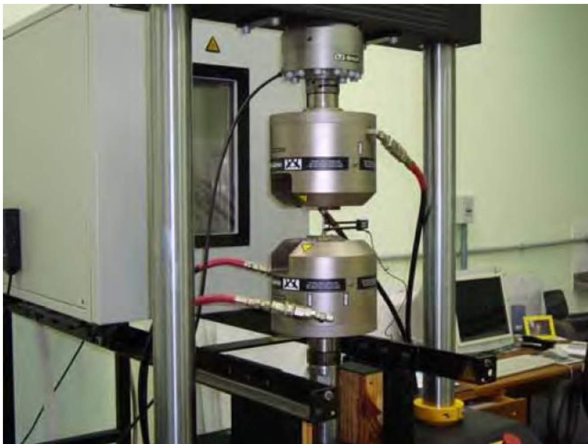
Figura 21 - Fotografia da Máquina de Ensaio Universal INSTRON 8801, utilizada no ensaio de tração (DMT FEG / UNESP).
