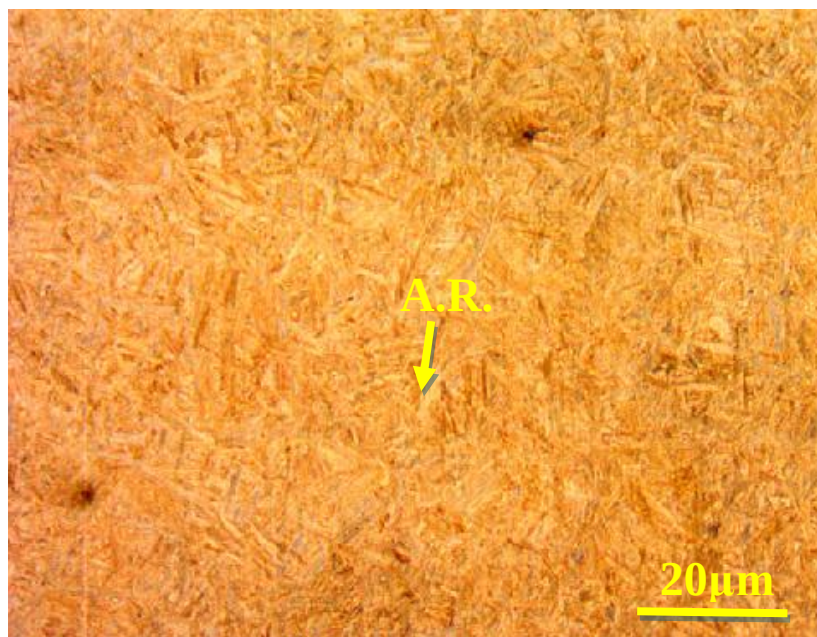
Figura 40 – Ataque químico: metabissulfito de sódio 10%. Condição B2 (850°C/ 280°C - 5400s). A.R. – Austenita Retida.
