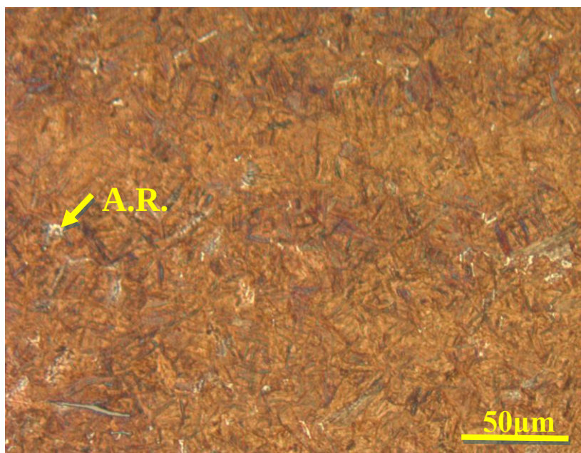
Figura 44 – Ataque químico: metabissulfito de sódio 10%. Condição 6 (850°C/720°C/ 210°C - 5 dias). A.R. – Austenita Retida.
