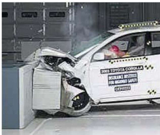
Figura 2 – Fotografia de um veículo submetido a cargas dinâmicas em um ensaio de impacto, Insurance Institute for Highway Safety (2002) (ANNIBAL et al., 2005).
