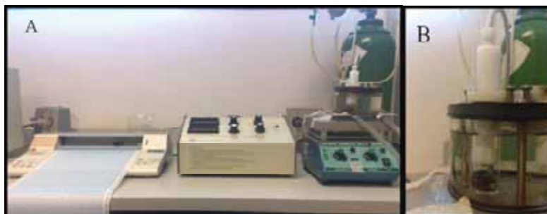
Figura 11. Aparelho YSI 5300A Oxygen Monitor (Yellow Spring USA). (A) O consumo de oxigênio molecular durante a reação constituída por ácido ascórbico 500 \mu M e naftoquinona 10 \mu M em de tampão PBS 10 mM, pH 7,4 a 37°C. (B) Em detalhe o sistema de reação fechado pelo eletrodo.
