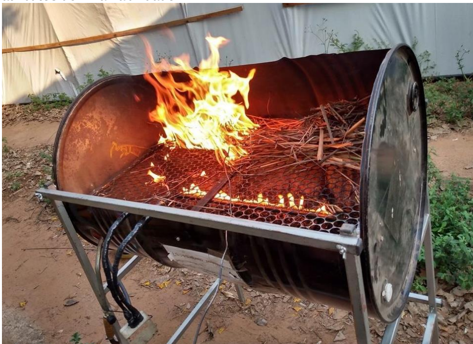
Figura 2: Visão geral da queima de um indivíduo no equipamento utilizado para a medição dos atributos de inflamabilidade.
