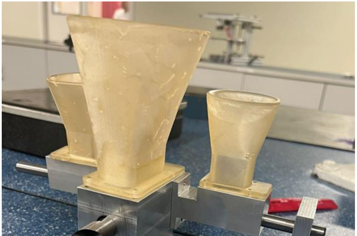
Figura 12 – Novos funis impressos pela tecnologia SLA
