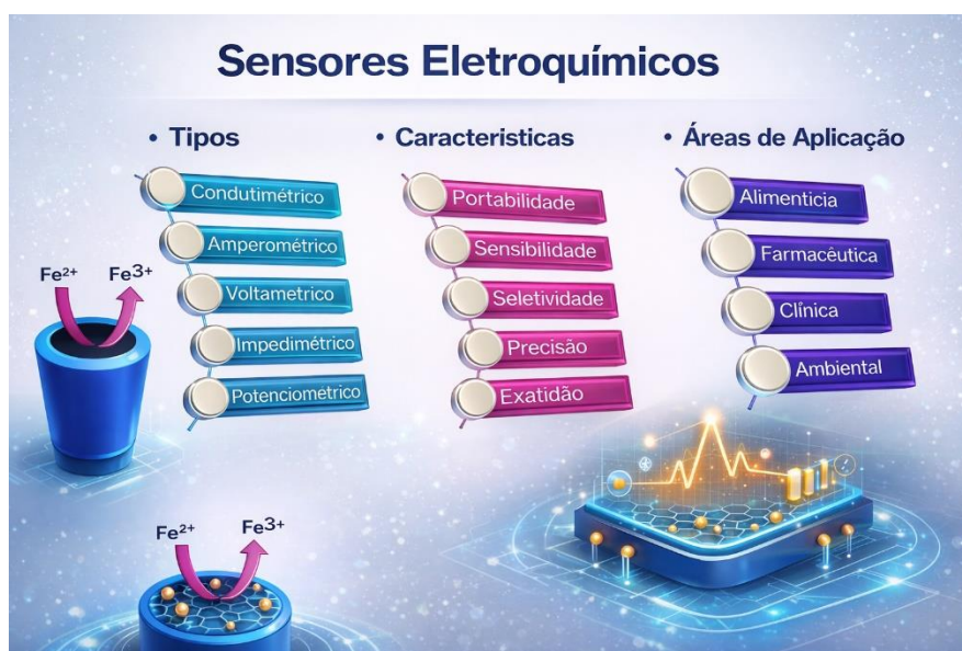
Figura 5: Tipos, características e aplicações de sensores eletroquímicos. Fonte: elaborada pelo próprio autor.
