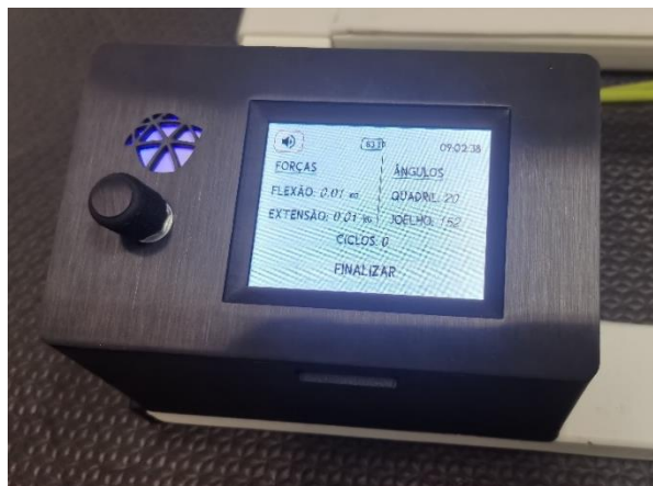
Figura 24 - Nova central eletrônica, com display 2,8 polegadas e encoder para navegação pelos menus.
