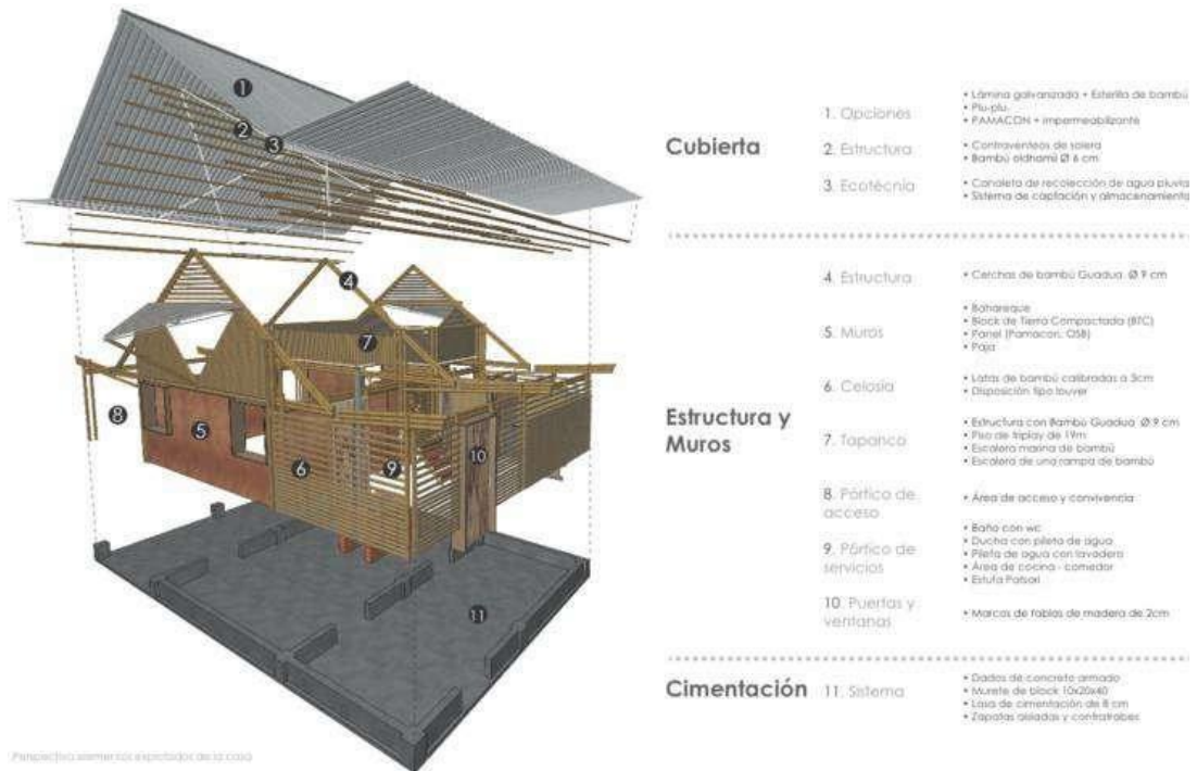
FIGURA 51 – Diagrama estrutura cobertura e sistema em bambu
