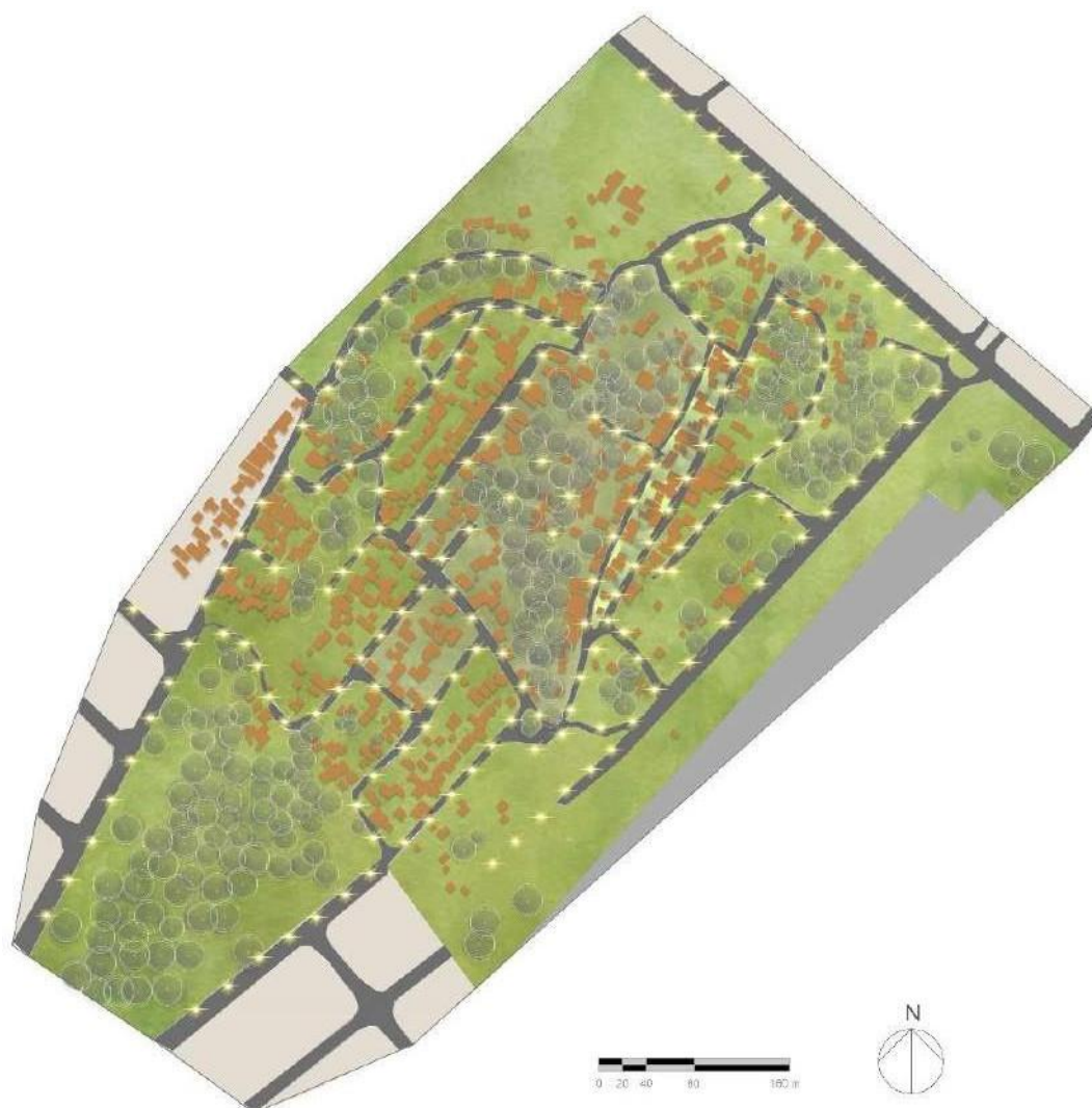
Figura 66 – Comunidade Renascer Sistema de Iluminação Pública
