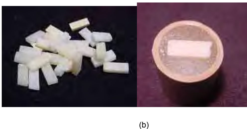
FIGURA 5 – (a) Fragmentos dos espécimes do ensaio de resistência à flexão; (b) fragmento do espécime incluído em resina acrílica para o ensaio de dureza.
