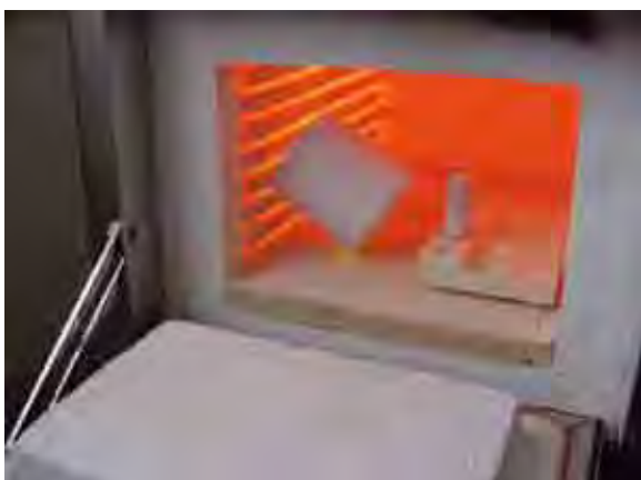
FIGURA 11 – Eliminação de cera no forno EDG 3000 e pré-aquecimento do êmbolo cerâmico.
