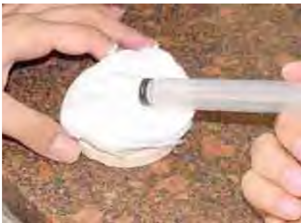
FIGURA 15 – Cilindro cerâmico compactado, removido da seringa hipodérmica.
