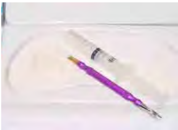
FIGURA 12 – Massa cerâmica aglutinada e seringa hipodérmica adaptada.
