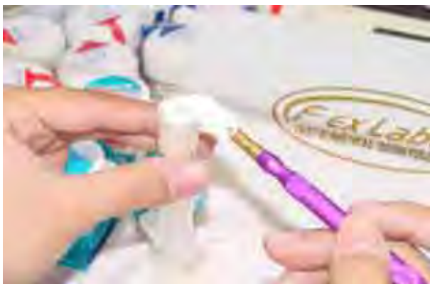
FIGURA 13 – Acomodação da massa cerâmica no interior da seringa hipodérmica.
