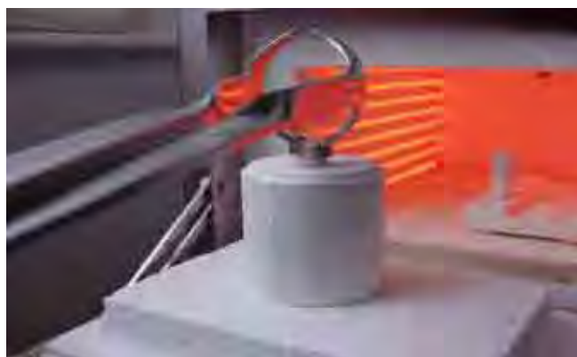
FIGURA 16 – Posicionamento do cilindro cerâmico; observa-se ao fundo o êmbolo cerâmico colocado a seguir no molde de revestimento.
