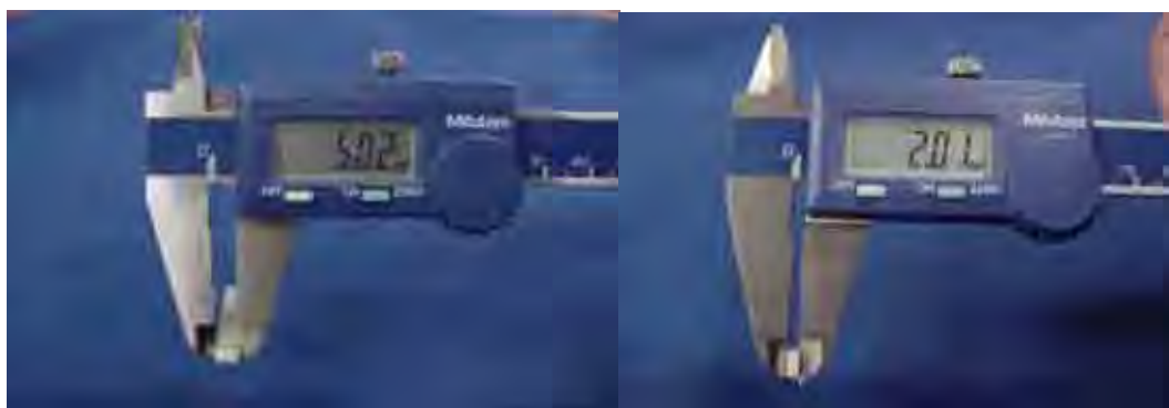
FIGURA 4 – Corpo de prova sendo medido por meio do paquímetro digital Mitutoyo 500-143B.
