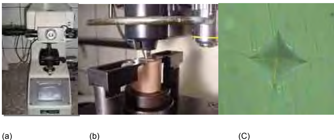
FIGURA 6 – (a)Ensaio de dureza Vickers em durômetro Buehler; (b) ponta ativa do durômetro Buehler; (C) Imagem da base da pirâmide formada pelo diamante do durômetro Buehler no espécime submetido ao ensaio de dureza Vickers.
