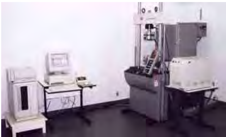
FIGURA 3 - Equipamento MTS-810 (Material Test System, EUA), gerenciado por programa Test Star II (IBM, EUA).
