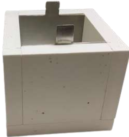
Figura 11 – Molde e eletrodos para a realização das medidas de Impedância Elétrica
