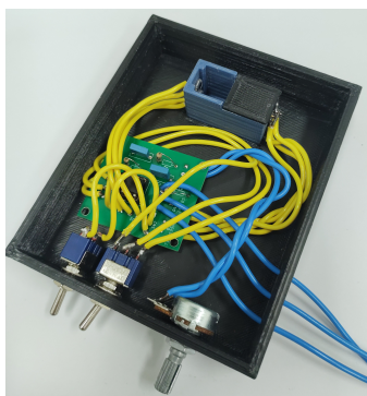
Figura 21 – Imagem do fotômetro construído. À esquerda, o local em que a cubeta é inserida, o circuito amplificador, e as chaves para os diferentes modos de operação. À direita, o fotômetro finalizado e ligado ao Arduino Uno.
