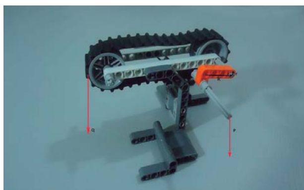
Figura 7: Montagem com peças LEGO (sarlho) para estudar conceitos de Força, Torque, Braço de alavanca, braço resistente.
