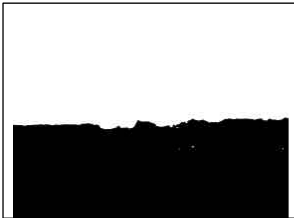
c) Imagem binária da figura antes da realização de "Fill Holes"
