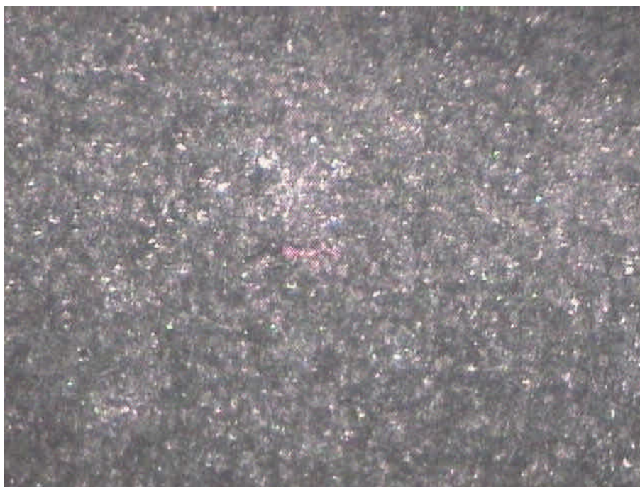
Figura 3.3 – Micrografia óptica da superfície da liga Al 2024 após a imersão em NaCl 3,5% na presença de \text{CrO}_4^{2-} 0,05 M
