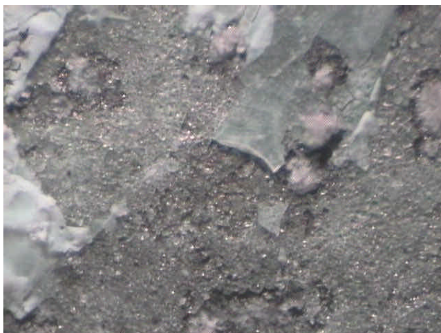
Figura 3.8 – Micrografia óptica da superfície da liga Al 7050 após a imersão em NaCl 3,5% na presença de \text{WO}_4^{2-} 0,05 M
