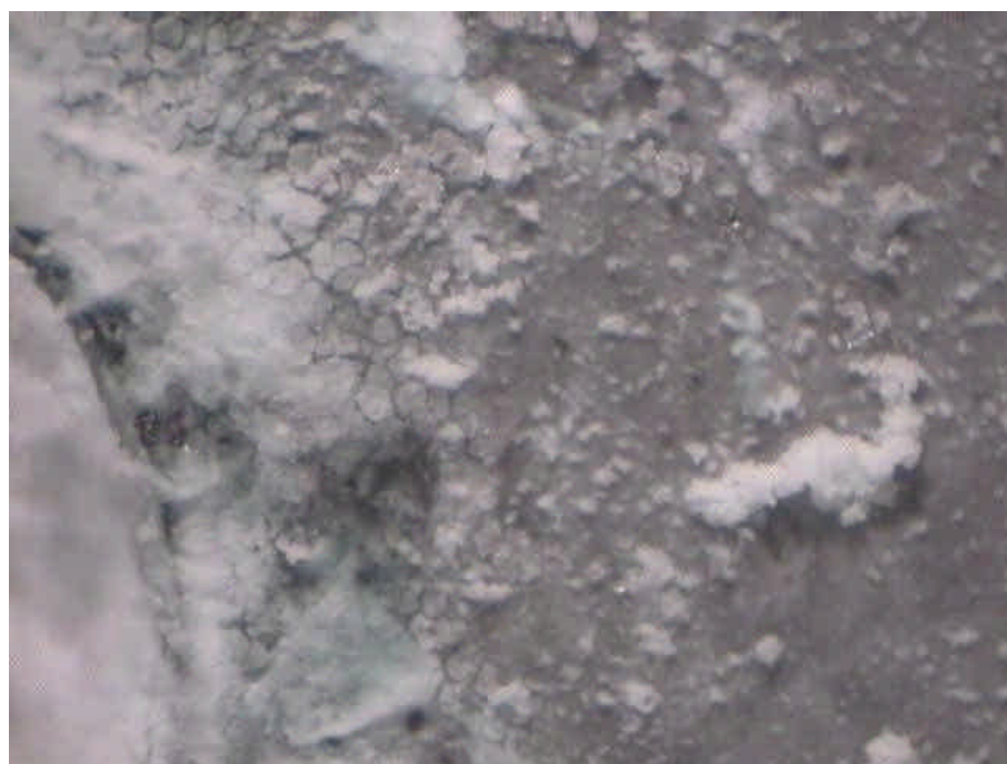
Figura 3.6 – Micrografia óptica da superfície da liga Al 7050 após a imersão em NaCl 3,5% na presença de \text{MoO}_4^{2-} 0,05 M
