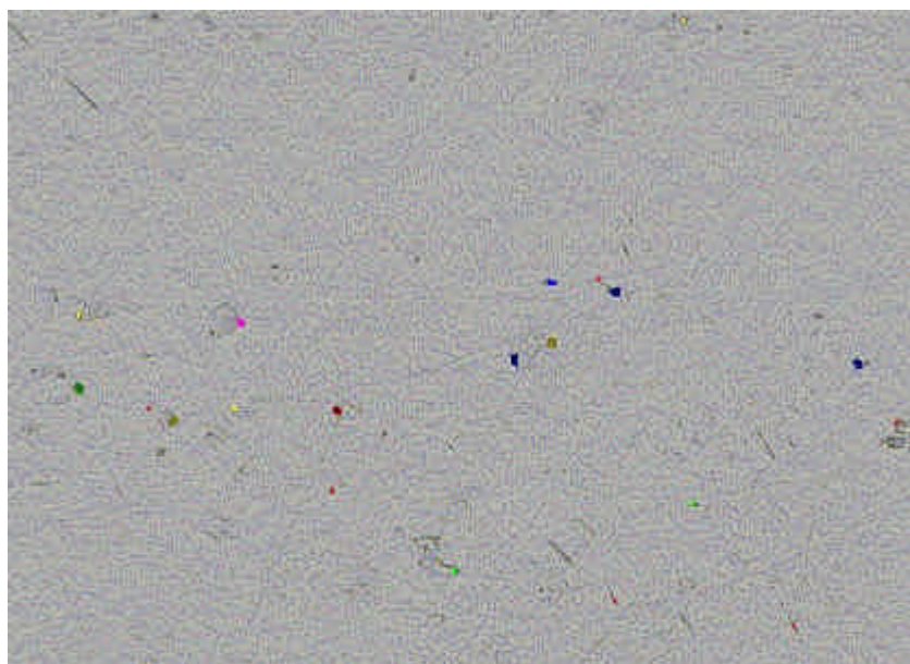
Figura 3.21 - Liga Al 2024 após imersão por 14 horas em NaCl 3,5% + \text{CrO}_4^{2-} 0,05 M. Observa-se um número reduzido de depósitos e pites, mostrando que a liga foi pouco atacada.
