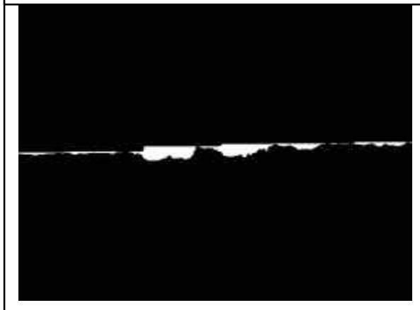
e) - Separação dos pites após erosão da figura 8d
