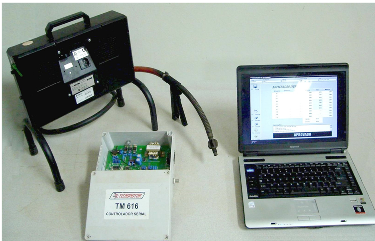
Figura 12. Instrumentação utilizada no ensaio de opacidade da fumaça (opacímetro, controlador serial, sonda de captação e computador com software IGOR) (LOPES, 2006)
