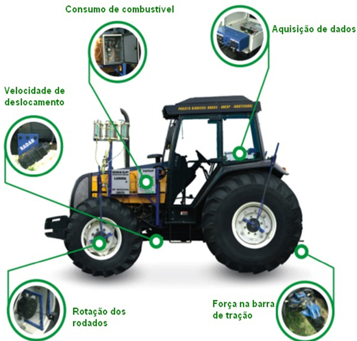
Figura 11. Vista lateral do trator-teste com instrumentação completa (LOPES, 2006)
