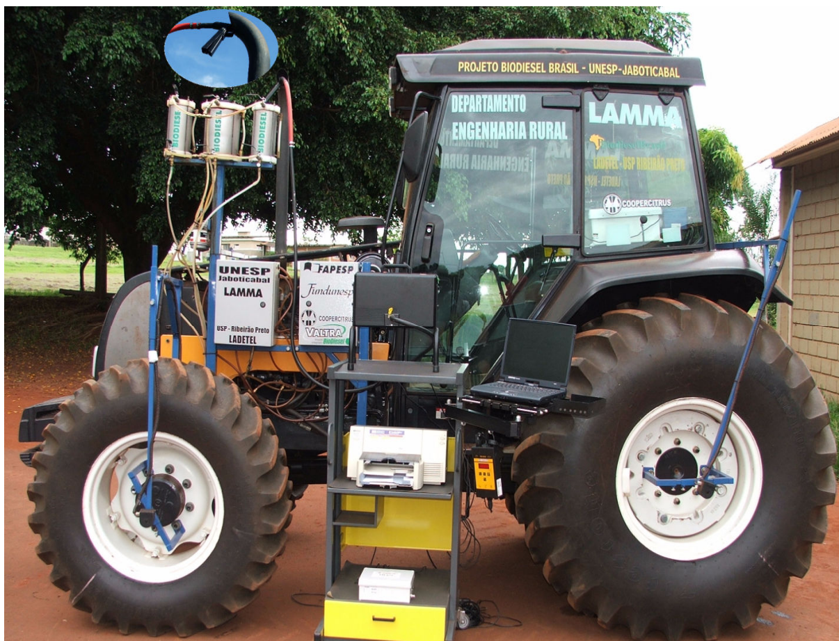
Figura 13. Vista geral do trator instrumentado para o ensaio de opacidade da fumaça (LOPES, 2006)
