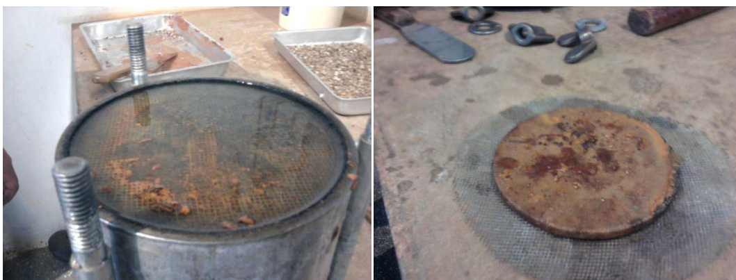
Figura 109 – Limo ferruginoso encontrado na desmontagem dos permeâmetros
