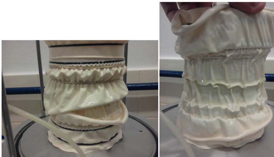
Figura 96 – Descolamento da membrana devido à aplicação de contra pressão maior que a confinante.
