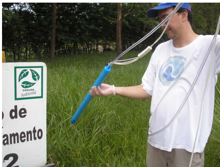
Figura 73 – Bomba de 5 estágios 12V da Proactive
