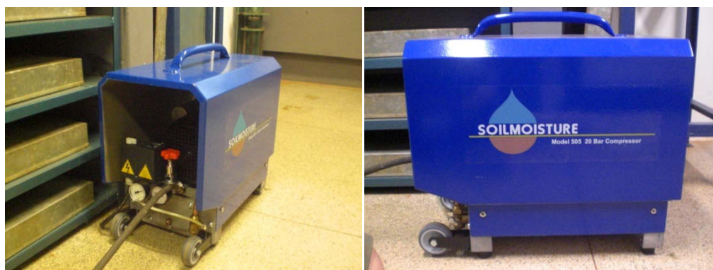
Figura 100 – Compressor da Soilmoisture com capacidade máxima de 20 Bar, utilizado como fonte pressão para o sistema.
