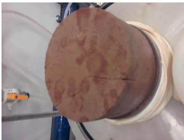
Figura 97 – Rompimento do corpo de prova durante ensaio de condutividade hidráulica em permeâmetro de parede flexível, devido à aplicação de pressão confinante muito maior que a contra pressão.
