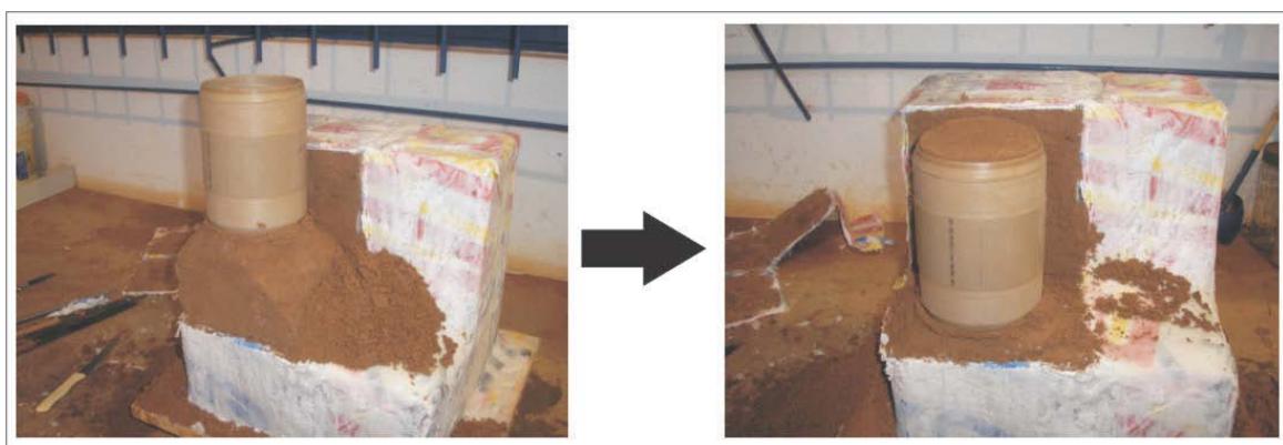
Figura 65 – Moldagem de corpo prova utilizando o permeâmetro de PVC
