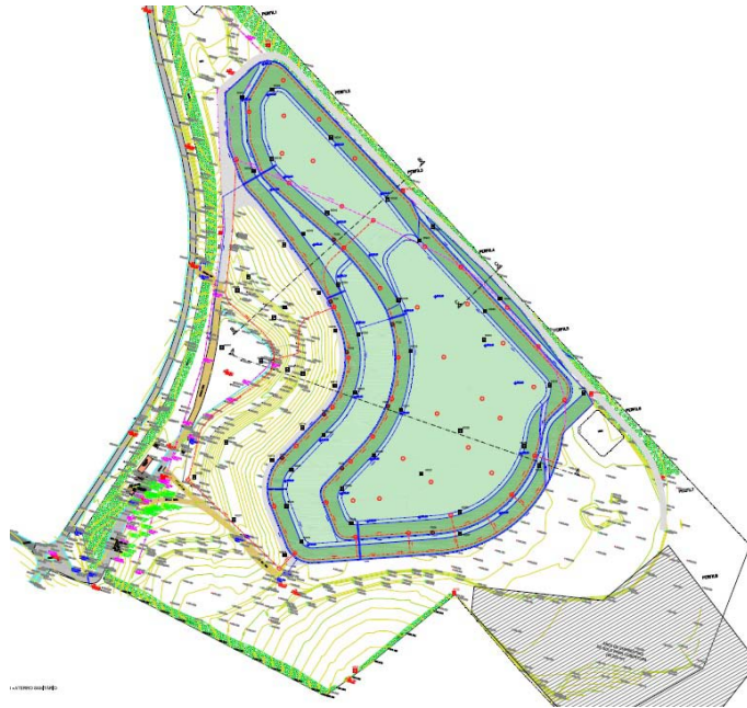
Figura 41 – Projeto do aterro aprovado, em verde as 4ª e 5ª camadas (EMDURB, 2010).
