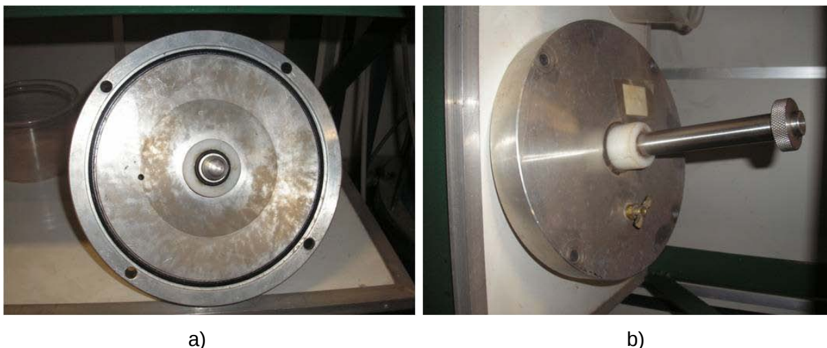
Figura 90 – Detalhe da tampa do permeâmetro de parede flexível: a) parte interna; b) lado externo.
