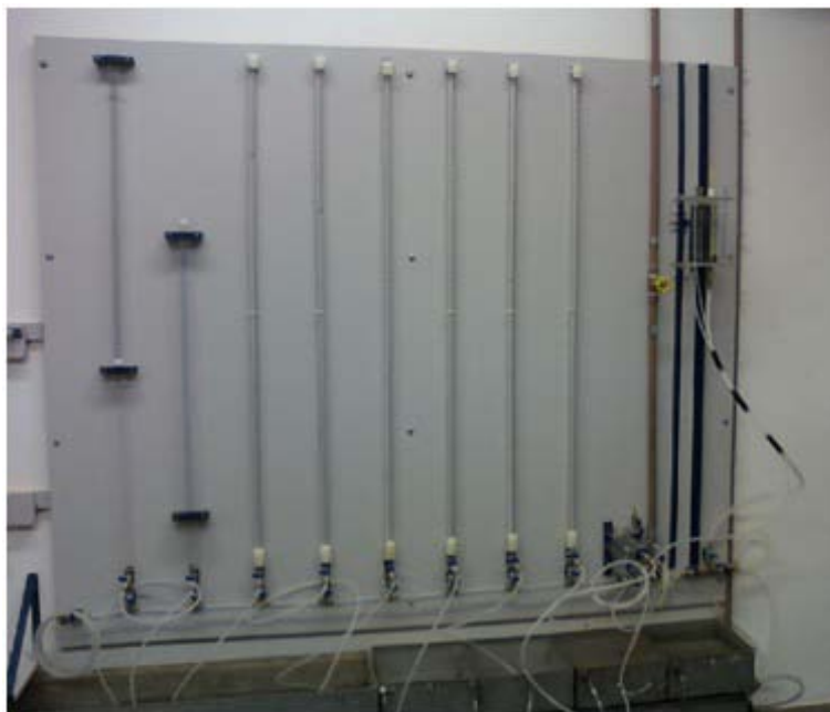
Figura 80 – Novo painel de permeabilidade
