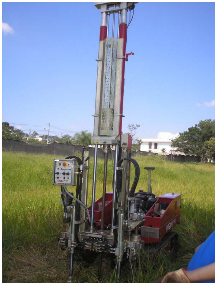
Figura 34 – Equipamento de cravação utilizado em ensaios de RCPTU
