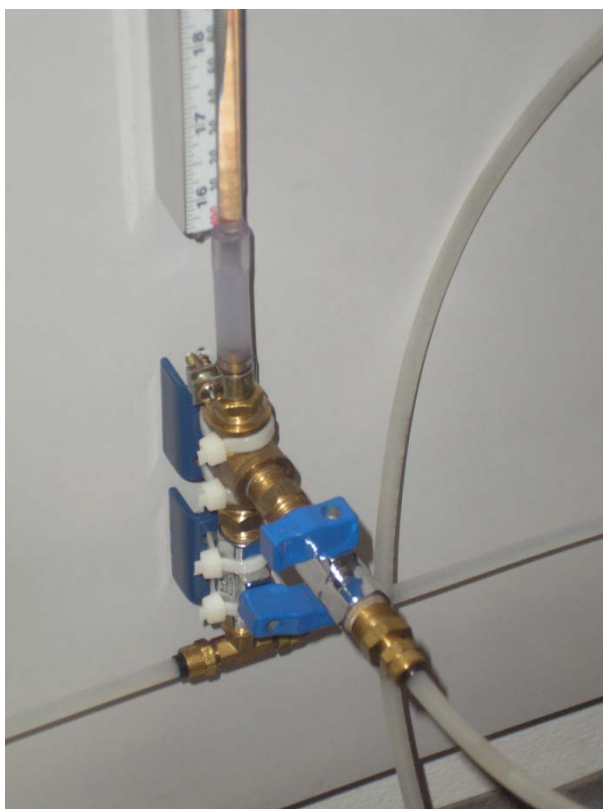
Figura 83 - Detalhe do conjunto de conexões acopladas ao tubo de carga através da mangueira de borracha.
