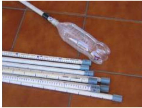
Figura 27 - Hastes graduadas para medida da elevação do nível d'água após seu esgotamento e bóia feita com garrafa de refrigerante PET de 2 litros (Mondelli, 2008).
