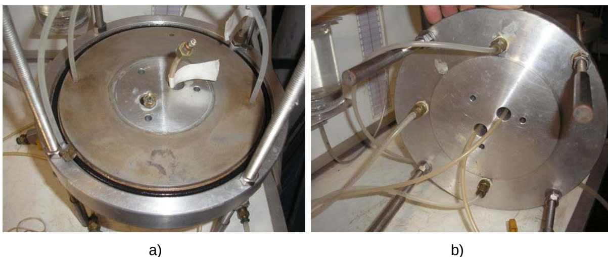
Figura 91 – Detalhes da tampa/base de duraluminíno sem a base de PEAD onde é montado o corpo de prova: a) lado interno; b) lado externo;
