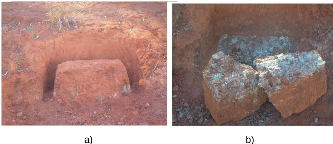
Figura 58 – Primeira campanha de coleta de amostra indeformada de solo coluvionar: a) bloco escavado; b) bloco danificado devido à trinca, onde nota-se o início da camada de solo residual na sua base.
