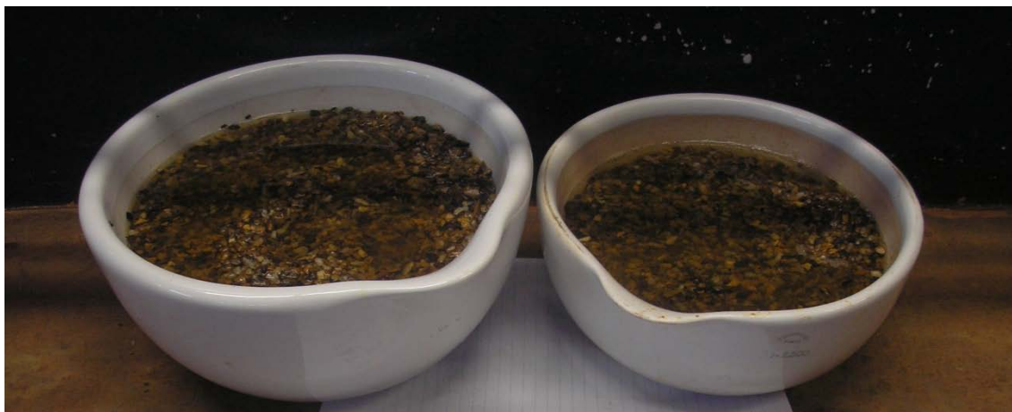
Figura 110 – Pedregulho em Banho de solução de HCl 18,5%
