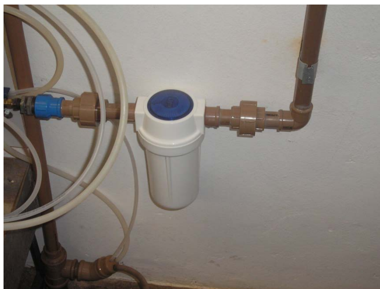
Figura 85 – Filtro de carvão ativado instalado no sistema de realização de ensaios de permeabilidade.
