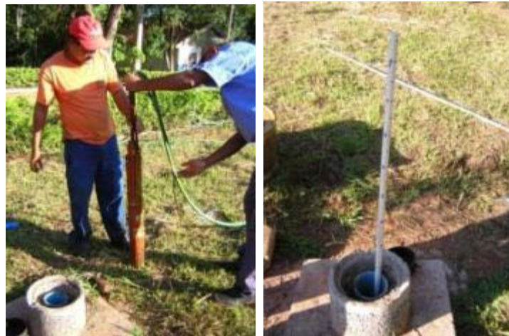
Figura 27 - Hastes graduadas para medida da elevação do nível d'água após seu esgotamento e bóia feita com garrafa de refrigerante PET de 2 litros (Mondelli, 2008).
