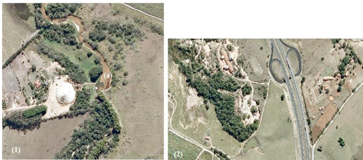
Figura 30 - Setor Leste (Fotografia aérea) / (1) Visualização a partir da fotografia aérea, áreas de mineração de areias e acarretando no (a) assoreamento do canal do rio e (2) áreas de mineração de argila e feições erosivas.
