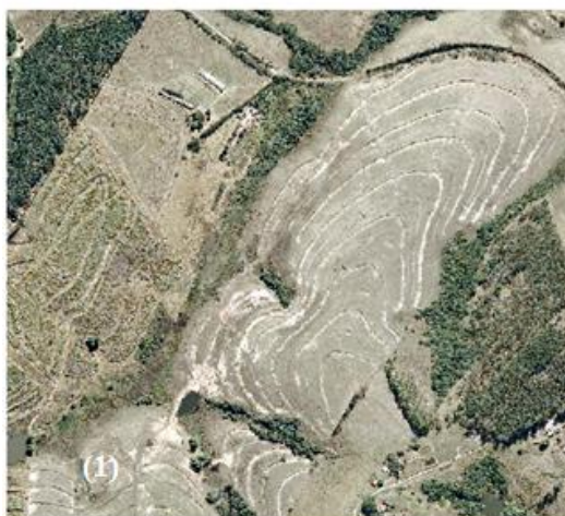
Figura 24 -Setor-Sul (Terraços)/ (1) Visualização do setor Sul a partir de fotografia aérea dos terraços amplos e altos, medidas que visam conter a erosão nas áreas de pastagens.
