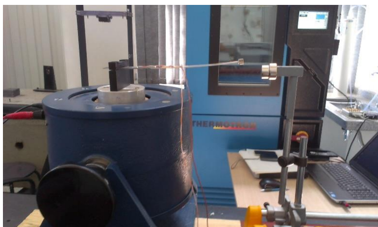
Figura 55 – Transição entre as condições de monoestabilidade e biestabilidade do sistema para d1=0,035m (distância entre magnetos) e amplitude de 2,5V_{pp} .
