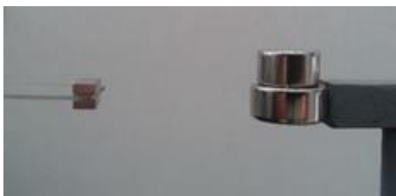
Figura 57 – Alteração da posição do ímã para análise da não linearidade. Amplitude de 3V_{pp} e d1=0,025\text{m} (distância entre magnetos).
