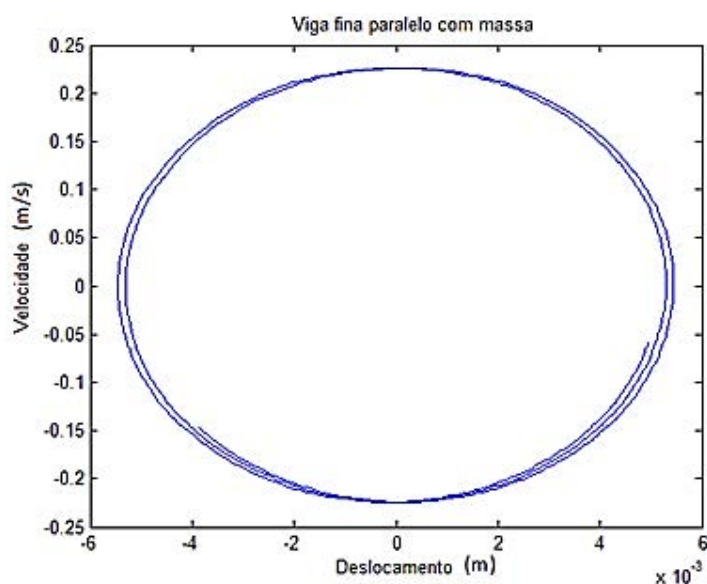
Figura 53 – Análise qualitativa para o caso linear considerando a viga fina com massa e PZT em paralelo.
