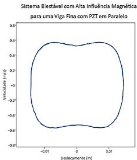
Figura 56 – Análise qualitativa para o caso não linear, viga fina com massa e PZT em paralelo considerando o sistema biestável e d1=0,035\text{m}
