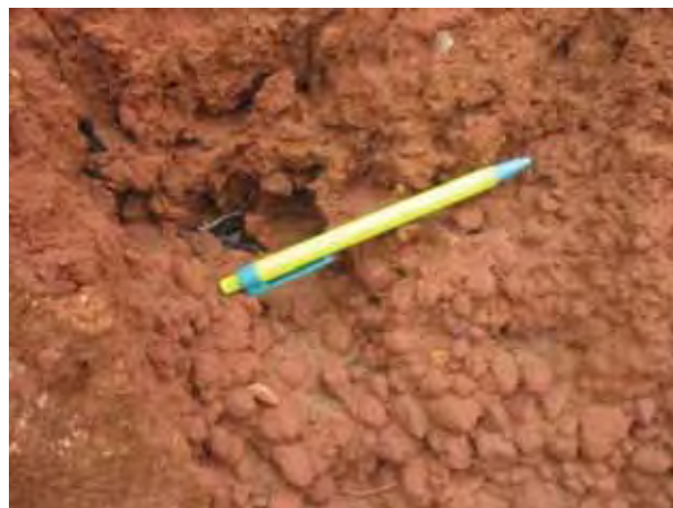
Foto 4. Solo eluvial areno-argiloso de coloração marrom avermelhada, laterizado e com abundantes nódulos formados pela concentração de óxidos e hidróxidos de ferro. (Ponto 14)
