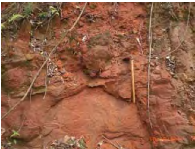
Foto 12. Arenito da Formação Botucatu bastante alterado sobreposto por solo coluvionar. (Ponto 7)
