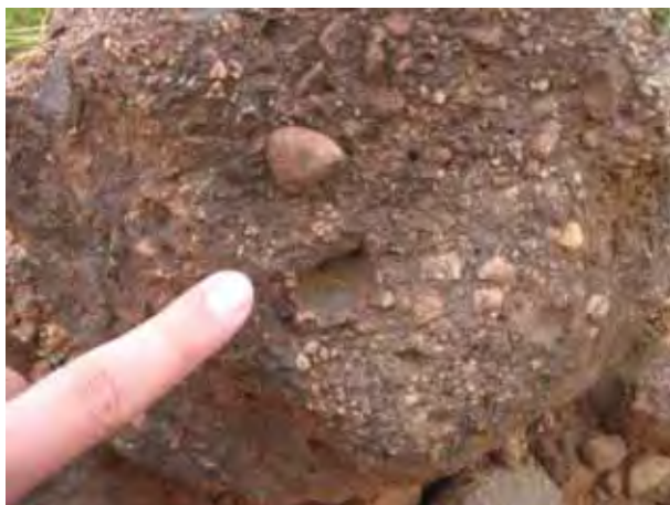
Foto 3. Bloco de arenito conglomerático da Formação Itaqueri, bastante cimentado e silicificado, com clastos de até 2cm (Ponto 16).
