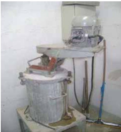
Figura 41- Aparelho do ensaio à abrasão
