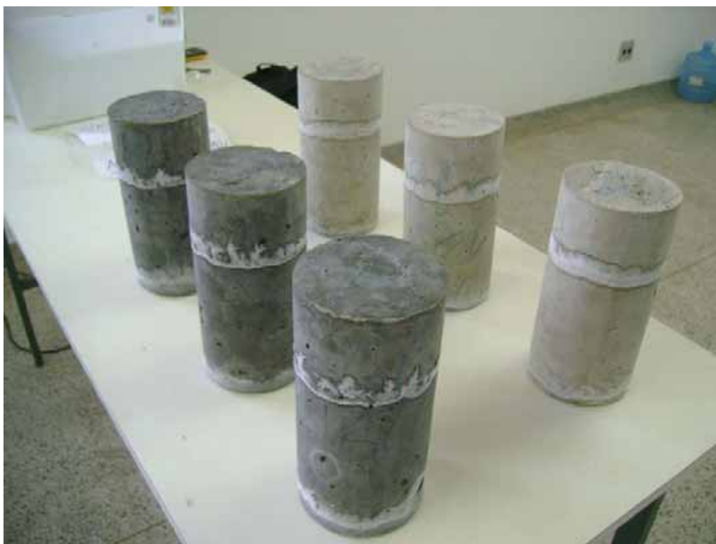
Figura 70 - No detalhe CPs depois de retirados da solução de NaCl
