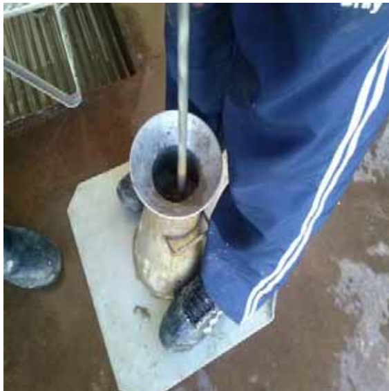
Figura 16 - Início do abatimento - golpes de adensamento
