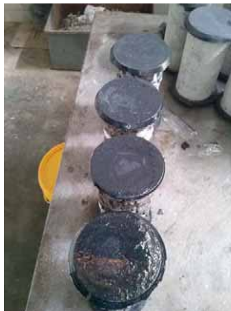
Figura 23 - Capeamento dos CPs c/ enxofre
