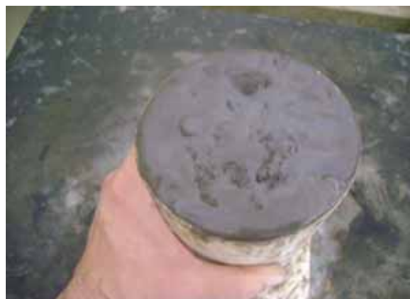
Figura 10 - Adensamento do concreto com CBC
