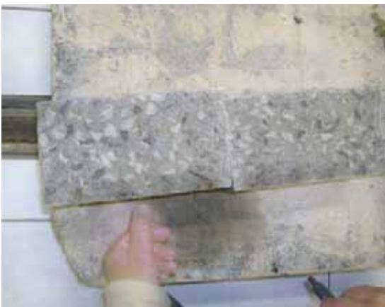
Figura 58 - CP Referência após rompimento
