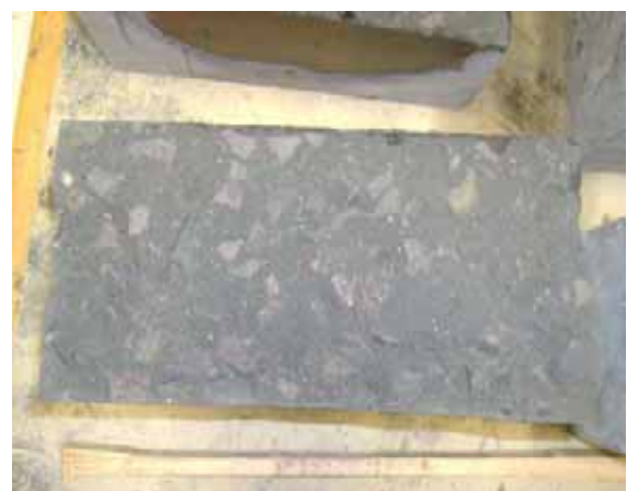
Figura 57 - Lâmina d' água penetração mínima CP CBC
