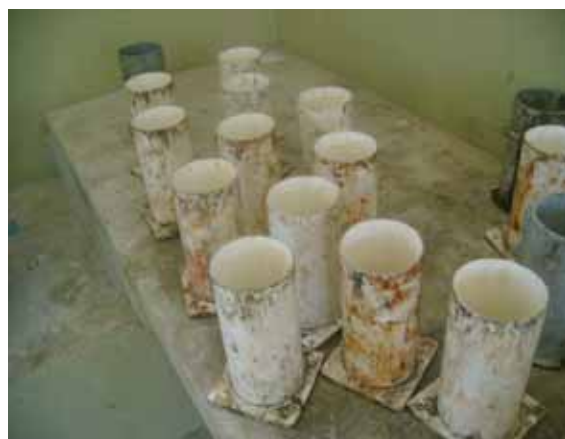
Figura 11 - Fôrmas para moldagem dos CPS
