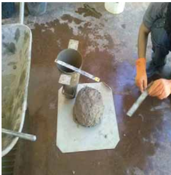
Figura 18 - Retirada funil para início da medição
