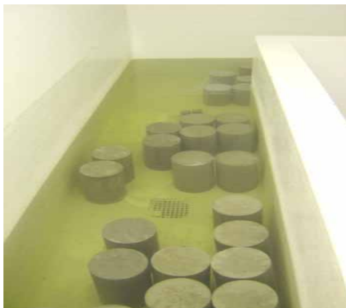
Figura 32 - Corpos de prova imersos em água
