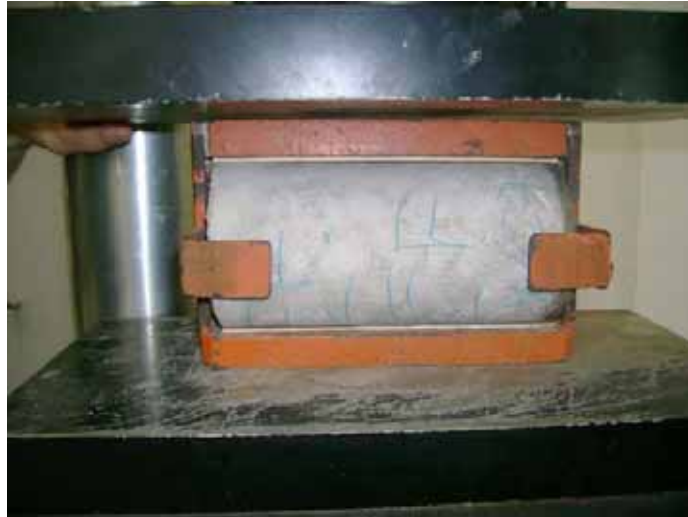
Figura 25 - Ensaio de tração por compressão diametral
