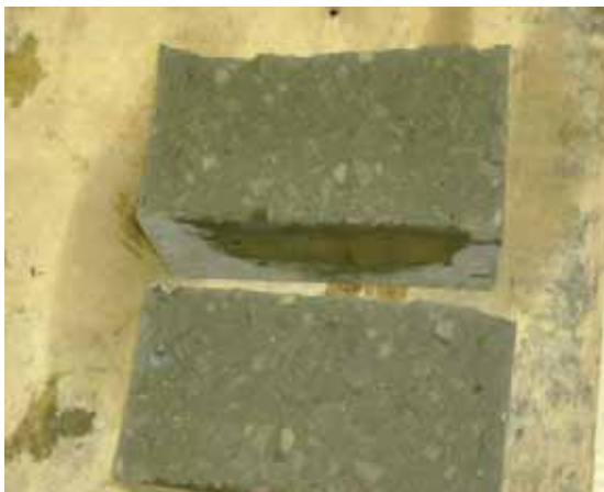
Figura 56 - CP de CBC após rompimento
