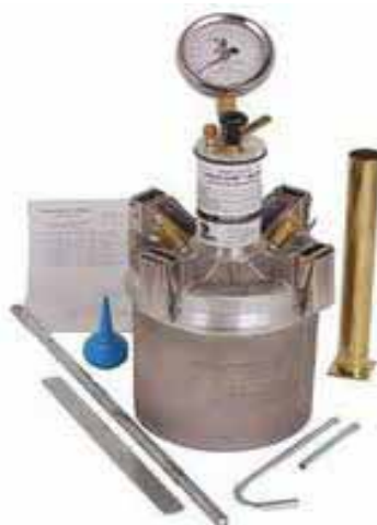
Figura 20 - Aparelho para medir o ar incorporado ao concreto
