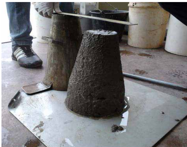
Figura 15 – Teste de abatimento do tronco de cone
