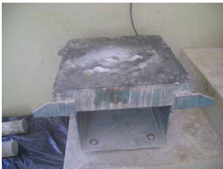
Figura 21 - Mesa vibratória para adensamento do concreto
