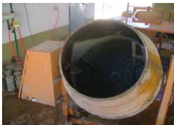
Figura 4 - CBC + brita + água + areia + cimento
