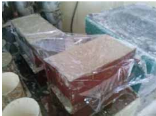
Figura 44 - Detalhe dos CPs após concretagem
