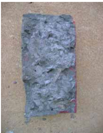
Figura 75 - Detalhe à direita “em vermelho” da penetração de íons de cloretos no CP com CBC .
