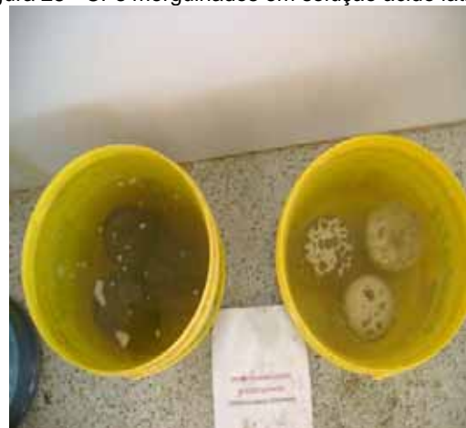
Figura 28 - CPs mergulhados em solução ácido láctico
