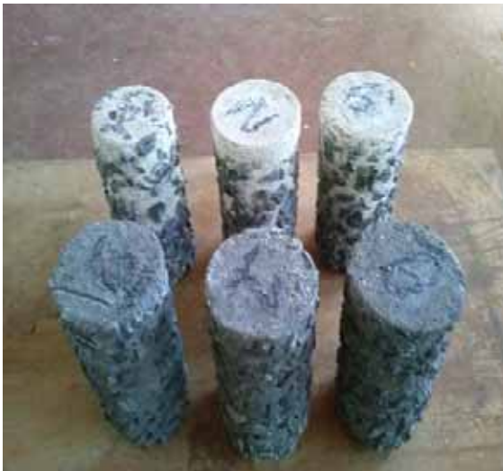
Figura 65 - CPs após o 2º ciclo ao ataque químico
