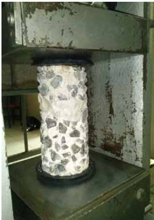
Figura 67 - Ensaio compressão do CP Referência
