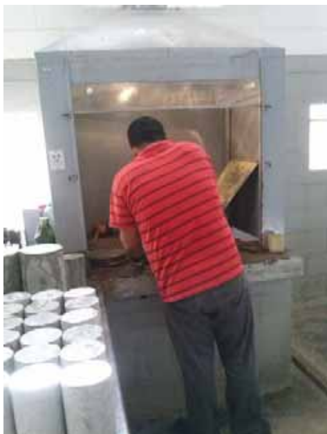
Figura 22 - Câmara de capeamento dos CPs
