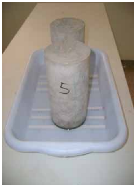
Figura 34 - Detalhe CPs em nível d'água de 5,0 mm
