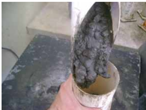
Figura 9 - Moldagem dos CPS de concreto com CBC
