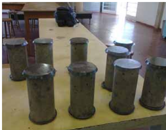
Figura 14 - CPS com capeamento de enxofre
