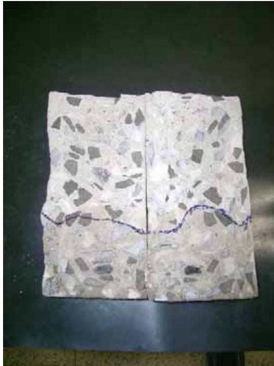
Figura 54 - Detalhe do nível (em azul) da lâmina de umidade por capilaridade no CP de Referência mais crítico
