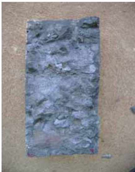
Figura 74 - Detalhe “em branco ” do início da reação com o nitrato de prata no CP de CBC
