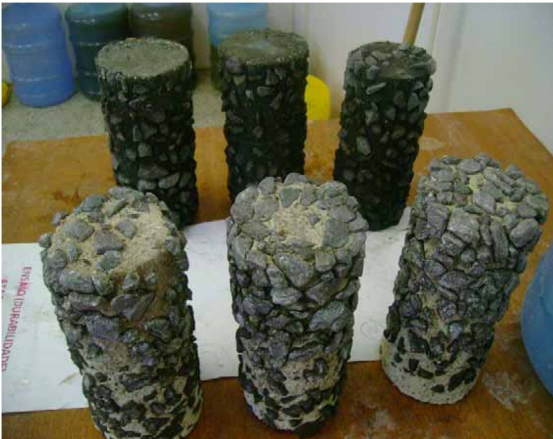
Figura 60 - Perda de massa do concreto como resultado da ação da solução contendo ácido láctico
