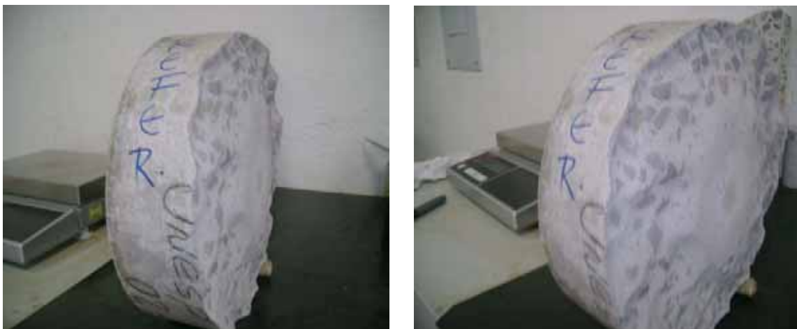
Figura 77 - Aparência após desgaste de 72 horas de ensaio de Abrasão /Erosão para CP de Referência
