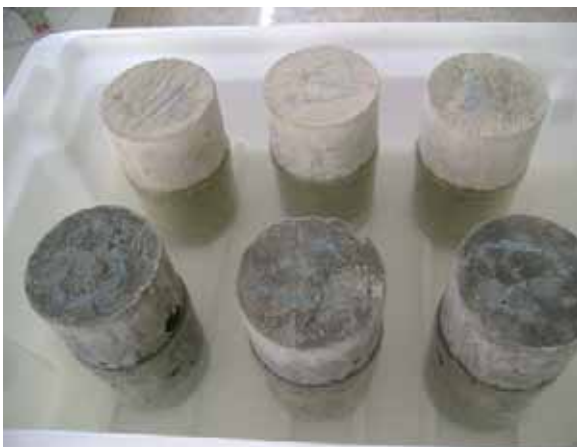
Figura 35 - Detalhe CPs imersos em solução NaCl
