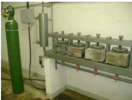
Figura 45 - Detalhe do ensaio de Permeabilidade
