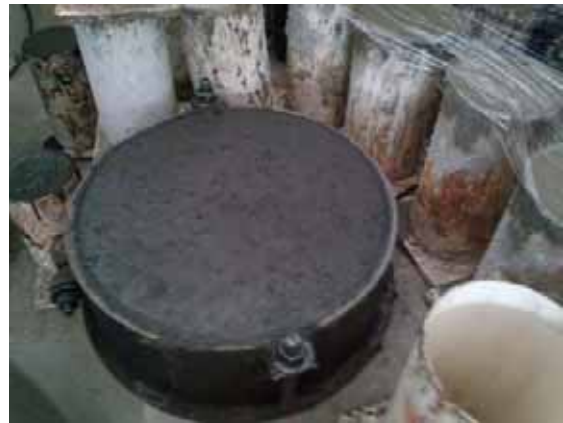
Figura 40 - Detalhe do CP após concretagem
