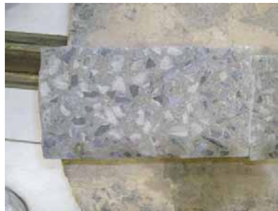
Figura 59 - Lâmina d'água de penetração do CP Ref.
