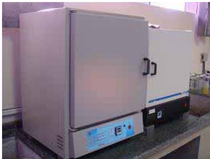
Figura 31 - Estufa para secagem dos corpos de prova
