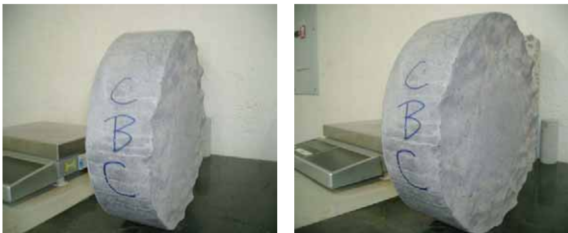
Figura 78 - Aparência após desgaste de 72 horas de ensaio de Abrasão /Erosão para CP de CBC
