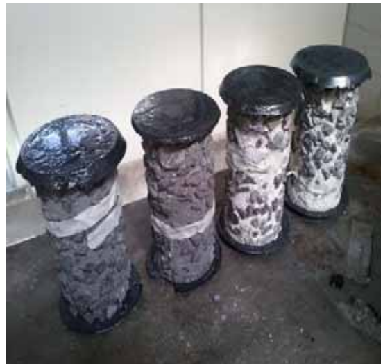
Figura 66 - CPs após o capeamento
