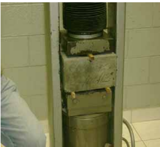
Figura 47 - Detalhe do CP na prensa hidráulica
