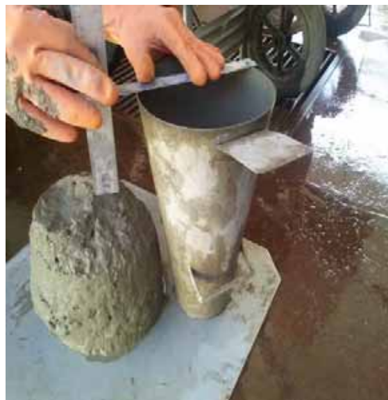
Figura 19 - Medição do valor do slump do concreto
