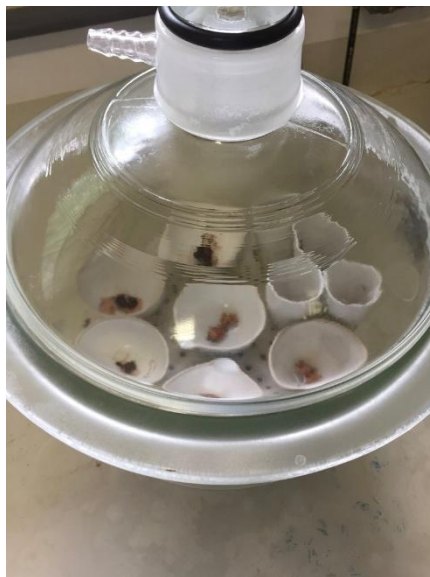
Figura 9 – Amostras de lodo de ETA e ETE no dessecador após 24 horas de secagem em estufa a 105 °C
