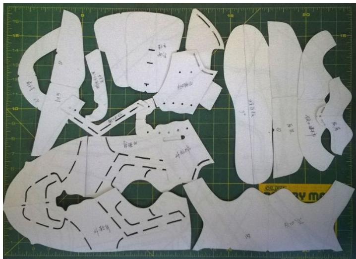
Figura 33 - Molde criado com todas as partes diferentes do calçado
