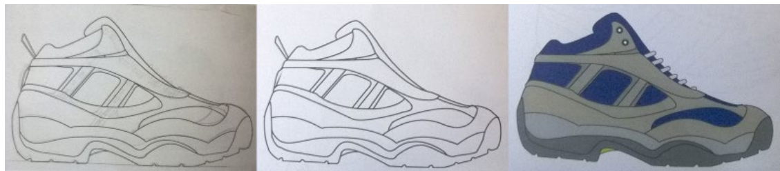
Figura 29 - Desenho feito a lápis, depois digitalizado e então renderizado com cores e texturas próximas do briefing
