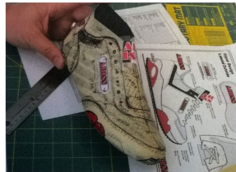
Figura 32 - Fôrma revestida com formas desenhadas
