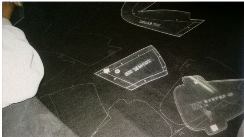
Figura 34 - Etapa de corte auxiliada por gabaritos
